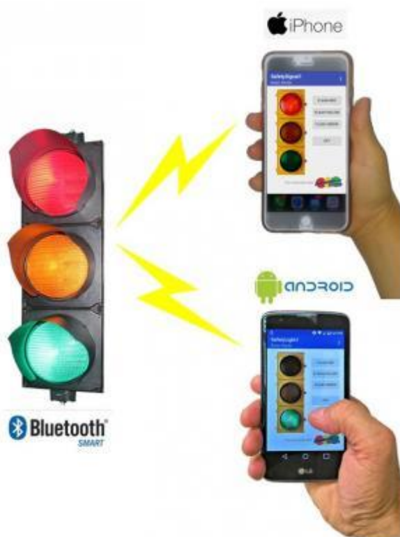
Εικόνα 28. Επικοινωνία κινητής συσκευής μέσω Bluetooth (πηγή: TrafficLights.com )
