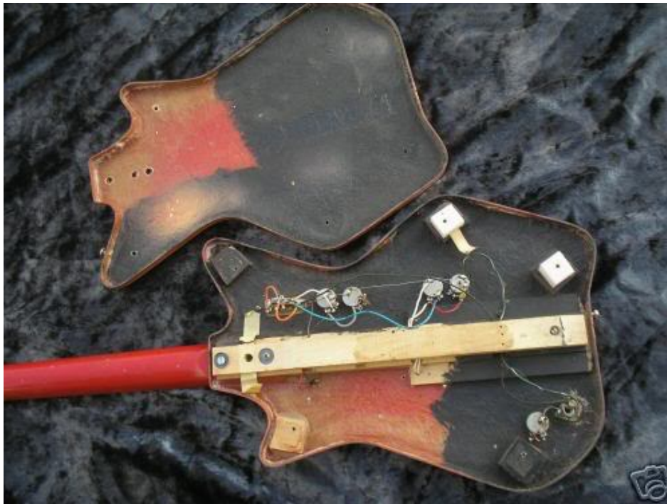
Εικόνα 15: το εσωτερικό μια κιθάρας airline , διακρίνεται καθαρά το ξύλινο δοκάρι [12]
