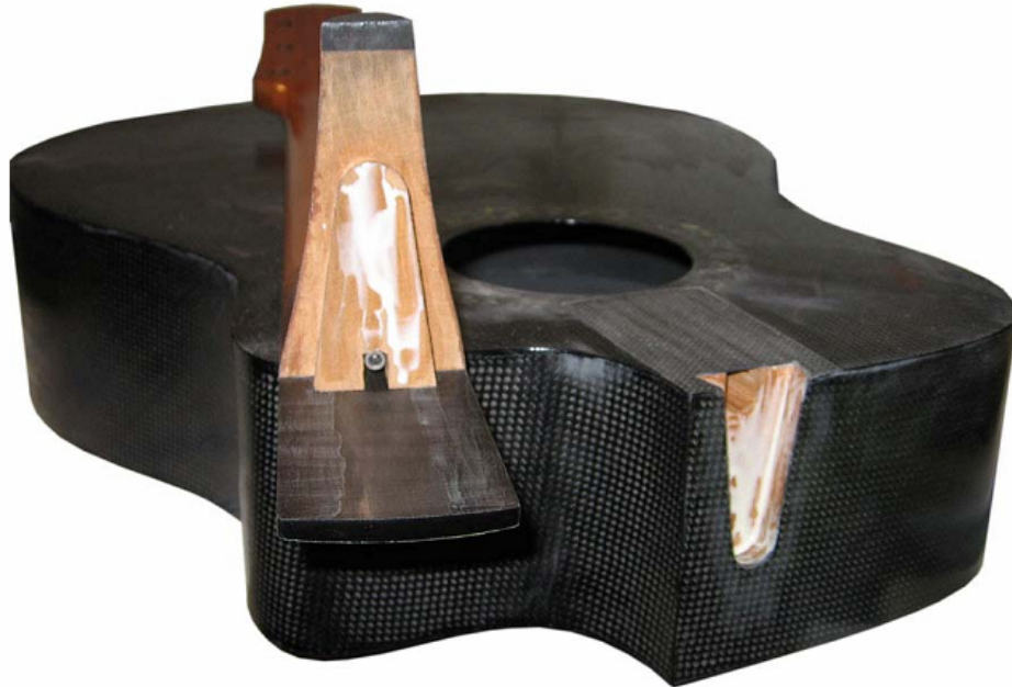
Εικόνα 63: διακρίνεται η ένωση μεταξύ μπράτσου και σώματος [46]
