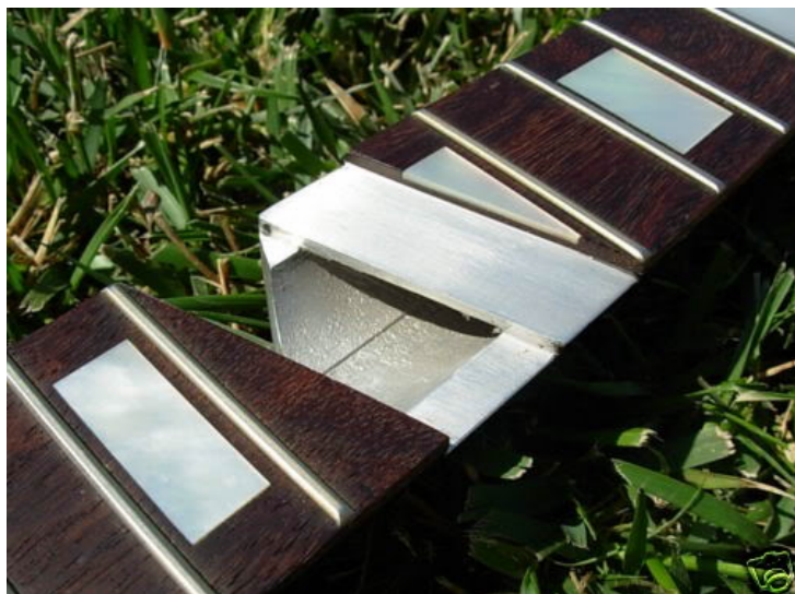
Εικόνα 20: φαίνεται καθαρά ότι το μπράτσο είναι κούφιο [13]
