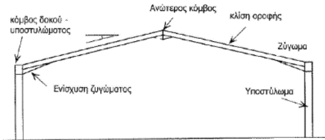
Σχήμα 2.10. Τυπικό πλαίσιο I
