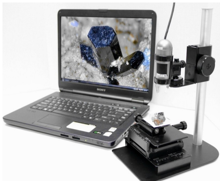
Εικ. 3 : Βιντεομικροσκόπιο συνδεδεμένο με ηλεκτρονικό υπολογιστή (διαδικτυακή πηγή www.dino-lite.com , 5/11/2017)
