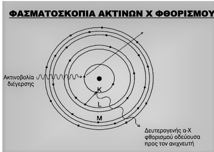
Εικ. 5: Το φαινόμενο εκτόπισης ηλεκτρονίου από το άτομο, κατάληψη της κενής θέσης του από άλλο ηλεκτρόνιο και εκπομπής (δευτερογενών) ακτινών-Χ φθορισμού (Λυριτζής 2016)
