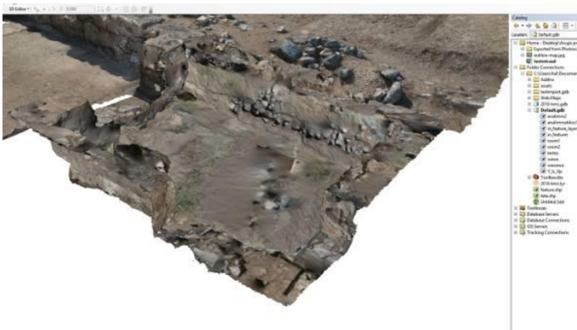
Εικόνα 39. Δείγμα του τυχαίου σφάλματος των αναίτια αλλοιωμένων Textures ενός μοντέλου κατά τη διάρκεια επεξεργασίας του στο ArcScene.
