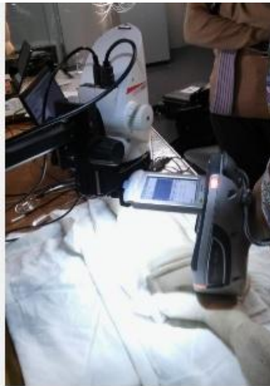
Εικόνα 13. Εφαρμογή της μεθόδου της φασματοσκοπίας φθορισμού XRF σε κυκλαδικό ειδώλιο στο μουσείο Κυκλαδικής Τέχνης. Πηγή φωτογραφίας: https://cycladic.gr/page/i-technologia-tou-marmarou-stin-protokikladiki-periodo ,
