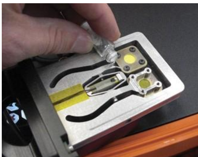
Εικόνα 15. Φορητή συσκευή XRD. Πηγή εικόνας : https://www.olympus-ims.com/sv/xf-xrd/mobile-benchtop-xrd/terra/#/
