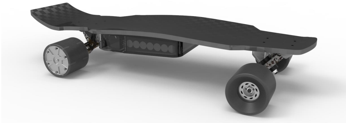
Εικόνα 55: Χώρος αποθήκευσης μπαταριών (πλάγια όψη)
