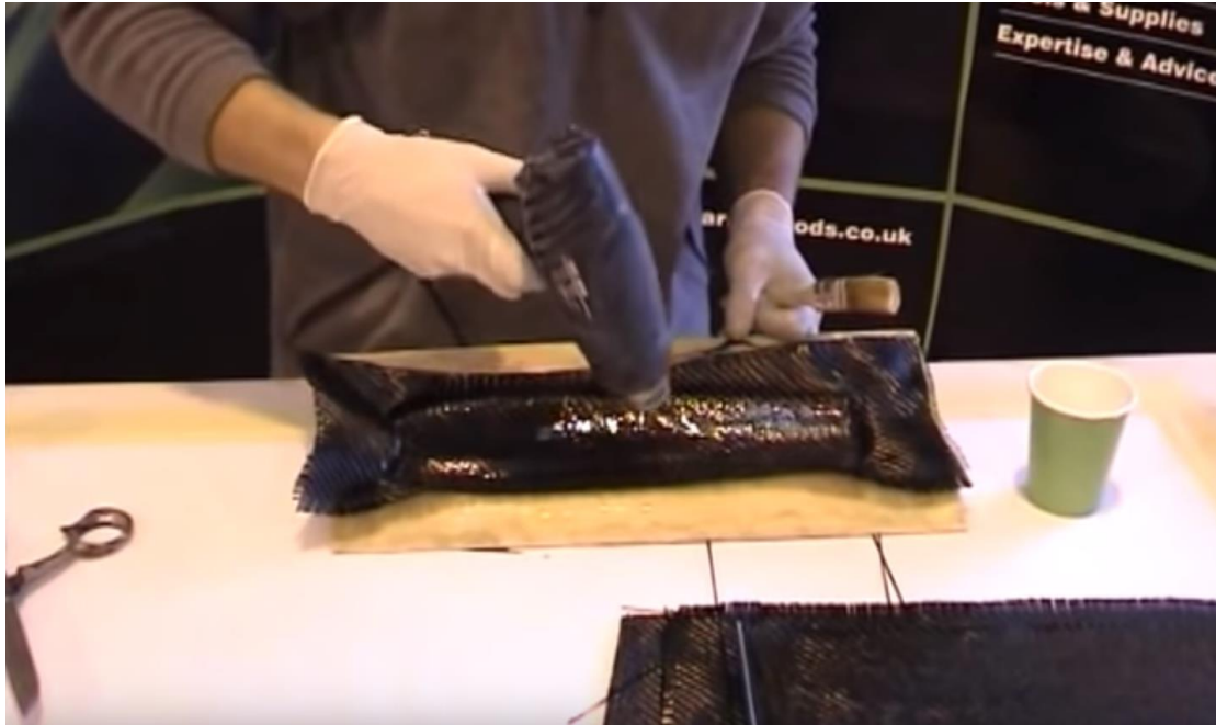
Εικόνα 111: Θερμαίνουμε για σκλήρυνση του υλικού
