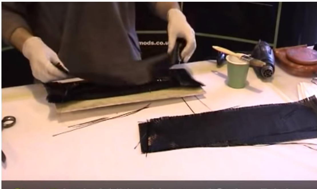
Εικόνα 112: Προσθέτουμε το επόμενο στρώμα ινών άνθρακα
