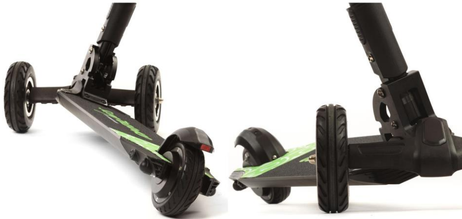
Εικόνα 18: Μηχανισμός lean to steer για στροφή δεξιά/αριστερά
