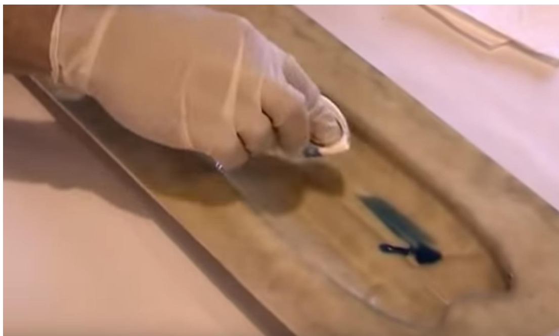
Εικόνα 106: Αλείφουμε την επιφάνεια με κεριό
