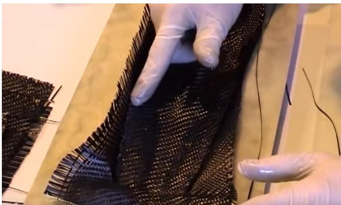
Εικόνα 109: Προσεκτική τοποθέτηση στις γωνίες
