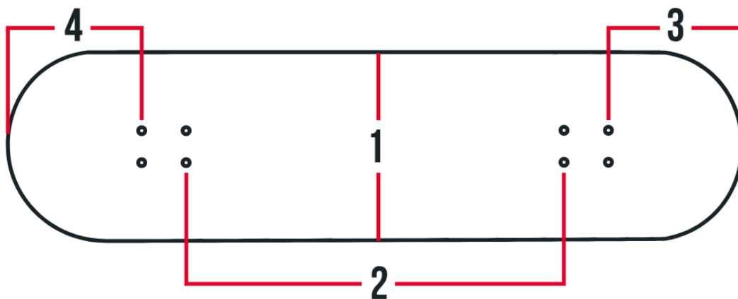
Εικόνα 9: 1.Deck width, 2.Wheelbase, 3.Nose, 4.Tail
