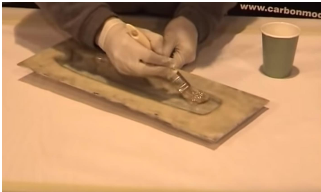
Εικόνα 107: Αλείφουμε το καλούπι με ρητίνη
