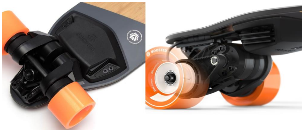
Εικόνα 24: Belt drive motors 1000W each
