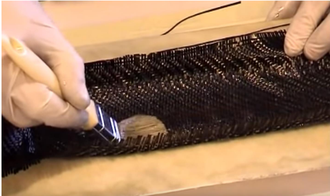
Εικόνα 110: εφαρμόζουμε επόμενη στρώση ρητίνης
