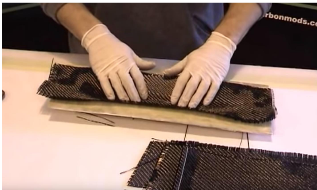
Εικόνα 108: Τοποθετούμε το πρώτο ινώδες ύφασμα
