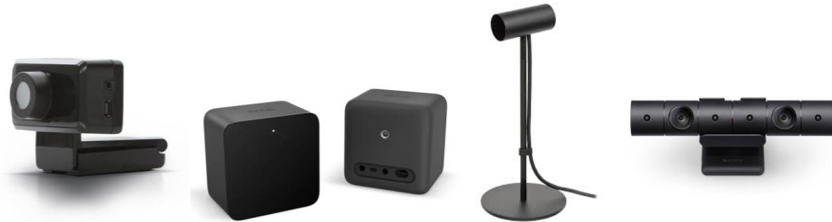
Εικόνα 13: Συσκευές παρακολούθησης θέσης (positional trackers) από αριστερά: Oculus Rift DK2 tracker, HTC Vive trackers, Oculus Rift CV1 tracker, PS (PlayStation) VR tracker.
