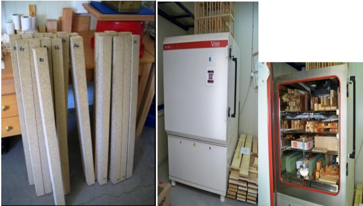
Εικόνα 4 (α) Τεμαχισμός πλακιδίων λυγαριάς σε κατάλληλη μορφή, πριν από την τελική τους διάθεση για την κατασκευή των πάνελ δόμησης, (β) Τοποθέτηση πλακιδίων λυγαριάς σε ειδικό ψυγείο κλιματισμού για βελτίωση τεχνητών χαρακτηριστικών.
