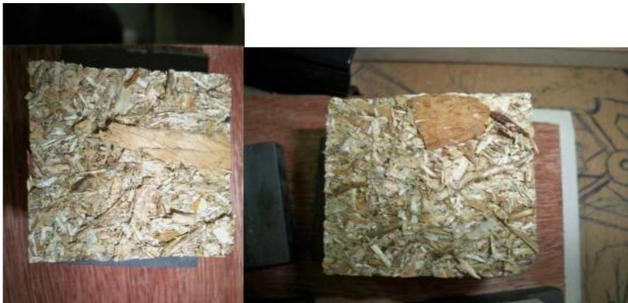
Εικόνα 5 Τεμάχια που προορίζονται για κατασκευή πάνελ δόμησης και έχουν δημιουργηθεί έπειτα από διαδικασία κατασκευής με ίνες λινარიού.
