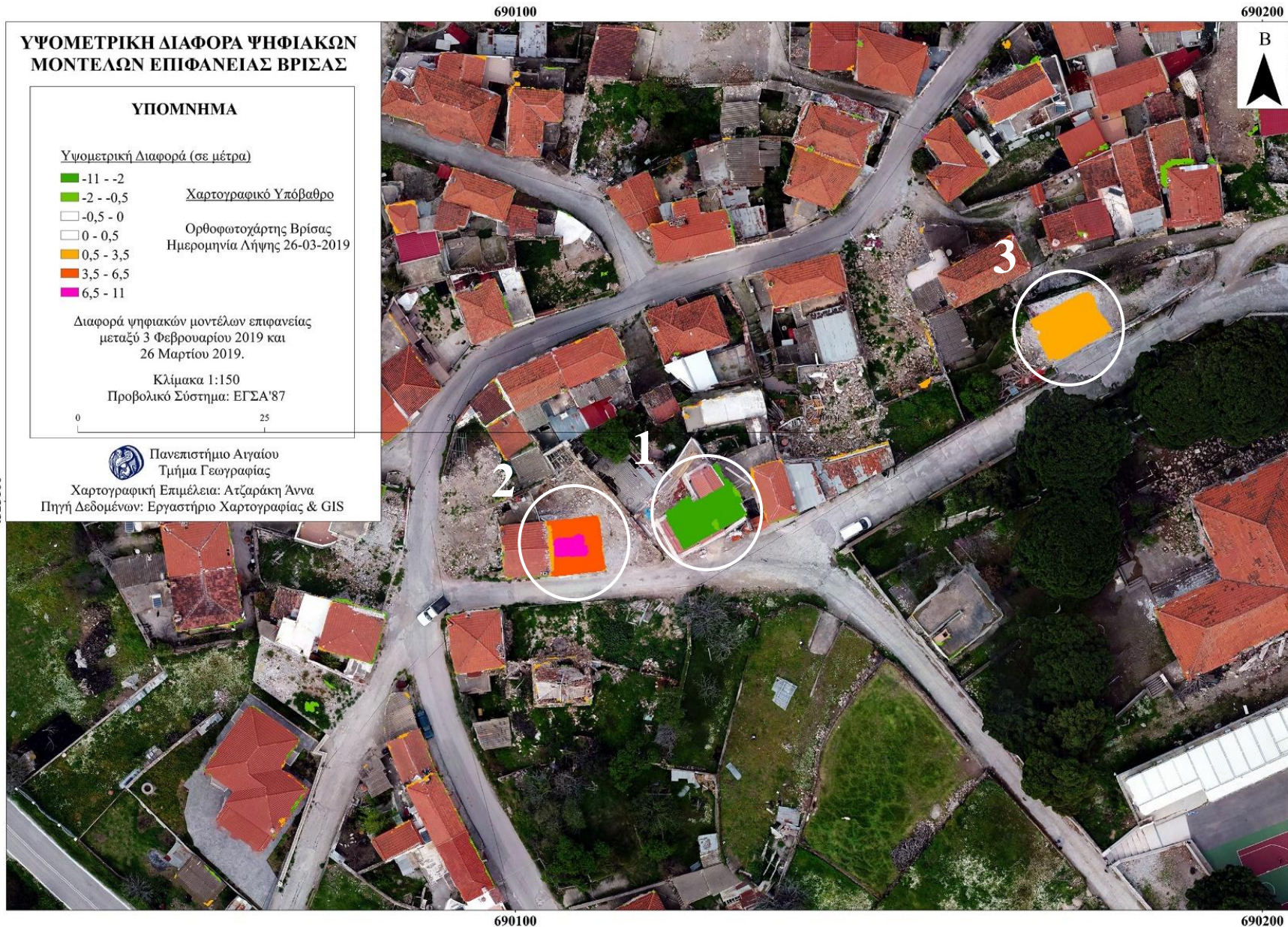
Χάρτης 16: Απόσπασμα διαφοράς DSM με δημιουργία κλάσεων σύμφωνα με το ύψος των ορόφων των κτιρίων αποτυπωμένο στον ορθοφωτοχάρτη 26/03/2019.
