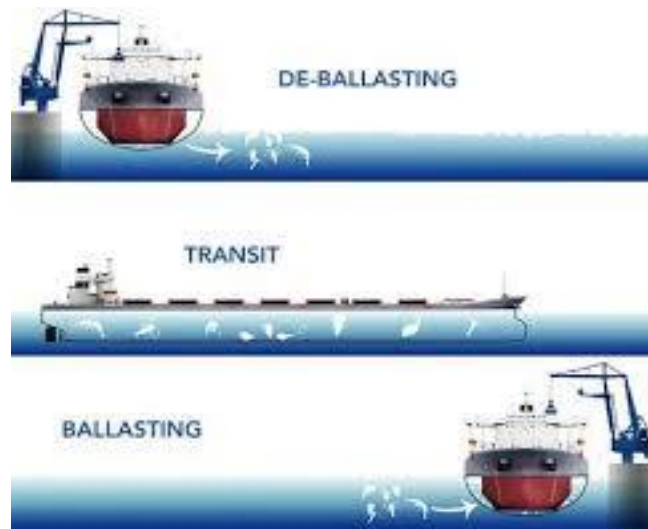
Εικόνα 10 Μέθοδος Ballasting - De-ballasting
