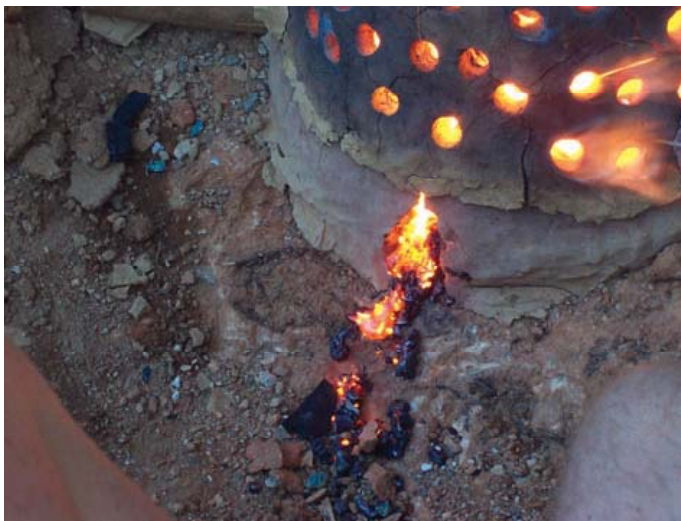
Εικόνα 4.7. Διαδικασία εκροής σκωρίας από τις πειραματικές μελέτες στο Χρυσοκάμινο. (Catapotis M., et al 2008.)
