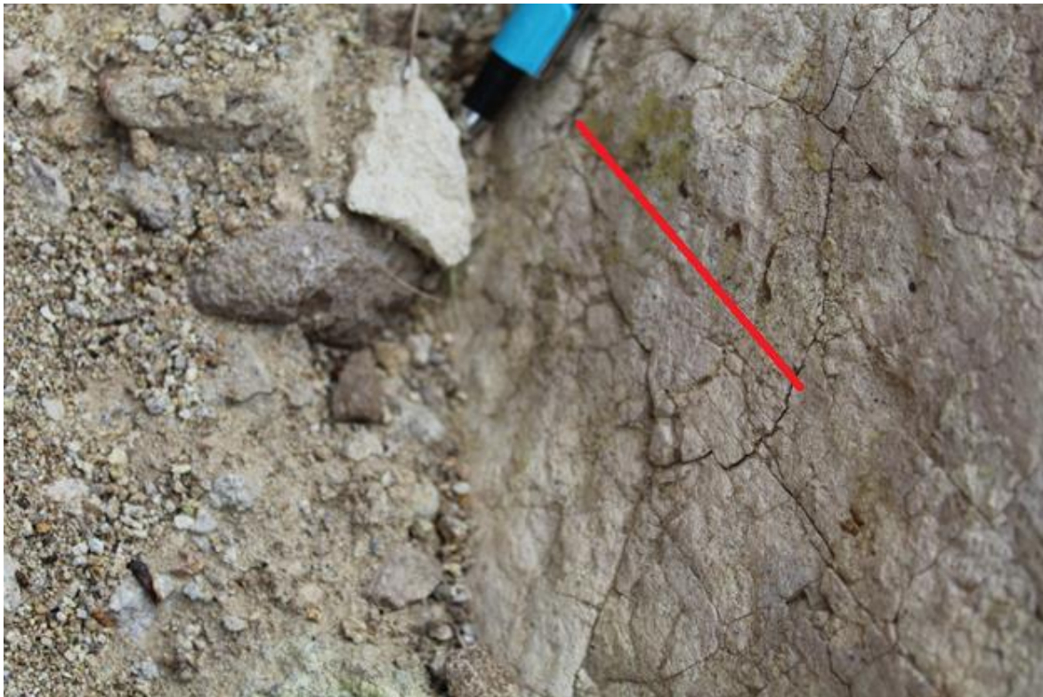
Εικόνα 295: Γράμμωση τεκτονικής ολίσθησης επιφάνειας Α.
