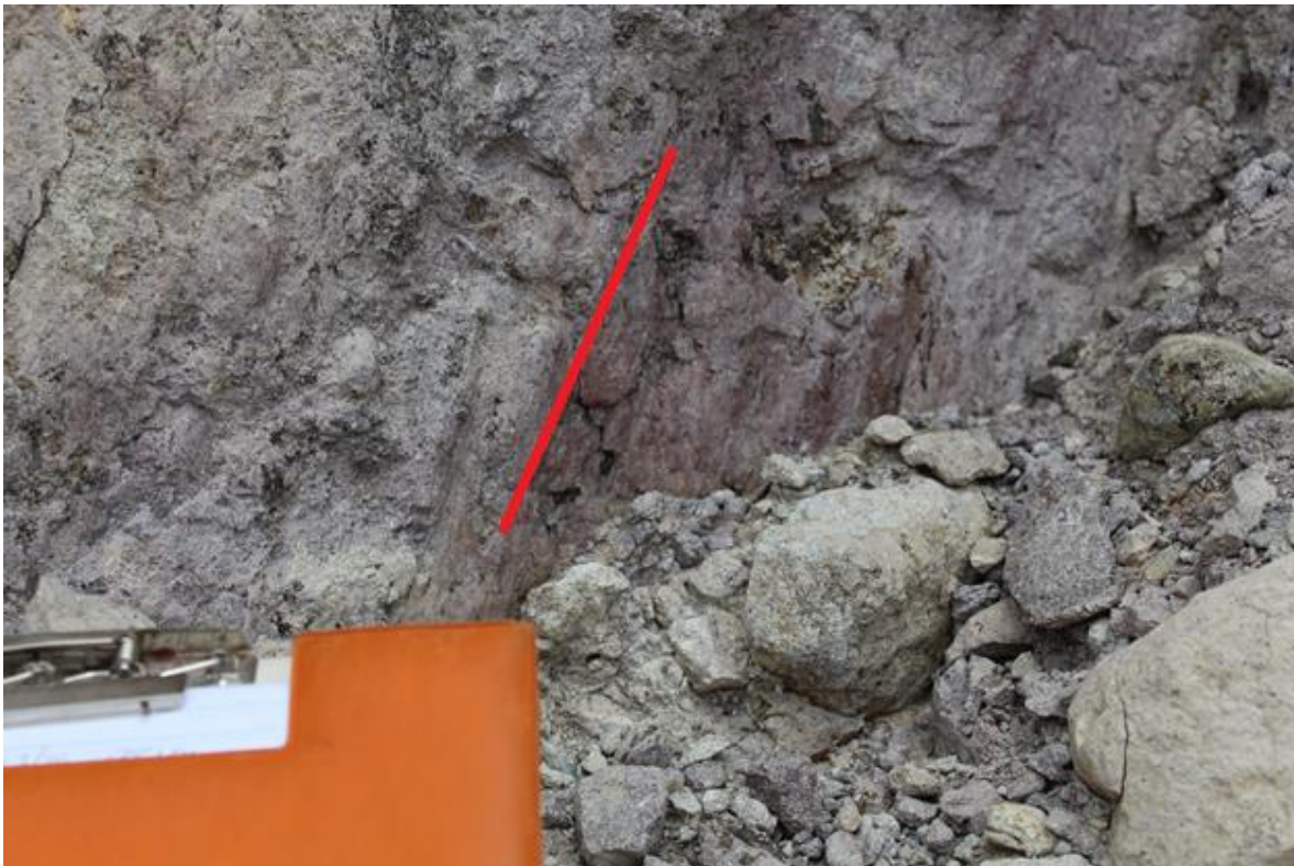
Εικόνα 297: Γράμμωση τεκτονικής ολίσθησης επιφάνειας Β.
