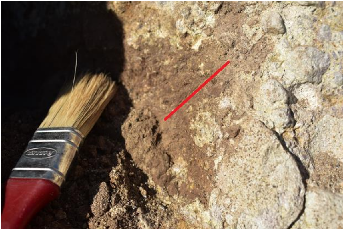
Εικόνα 84: Γράμμωση τεκτονικής ολίσθησης επιφάνειας Β.
