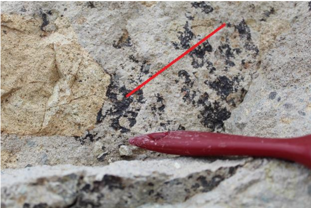
Εικόνα 258: Γράμμωση τεκτονικής ολίσθησης επιφάνειας Γ.
