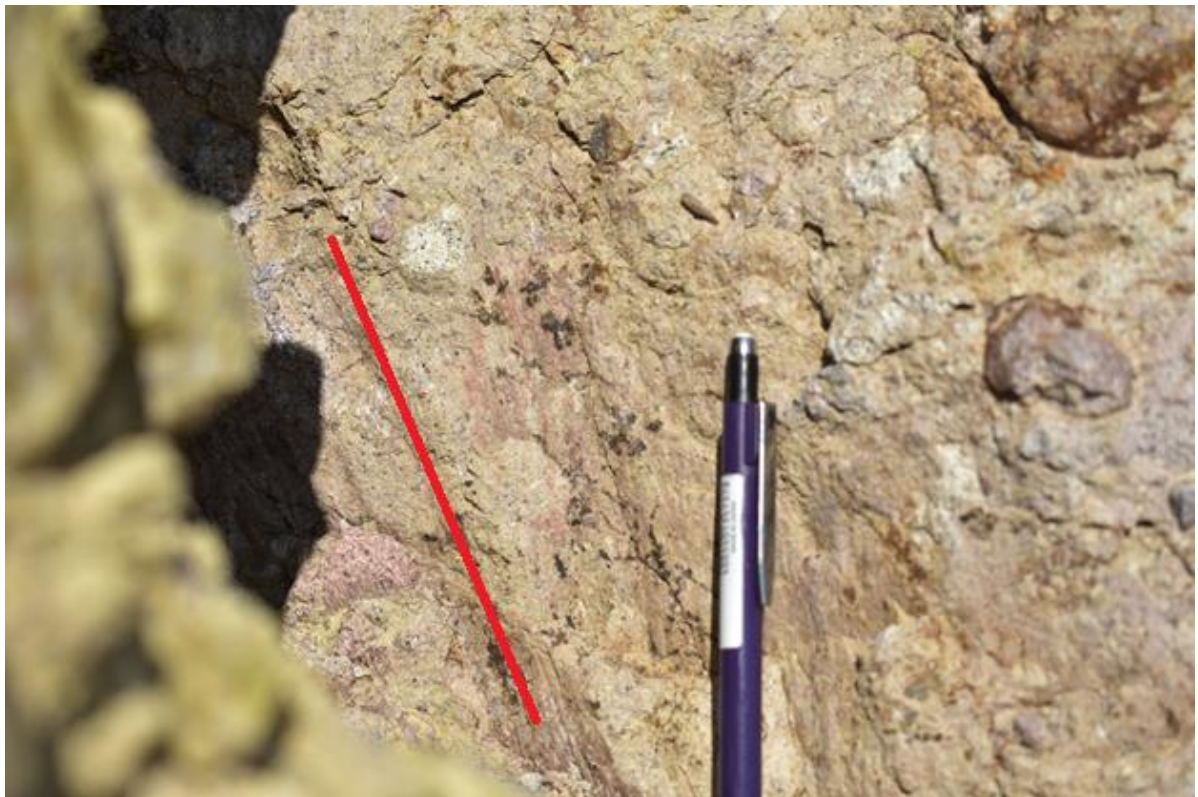
Εικόνα 67: Γράμμωση τεκτονικής ολίσθησης επιφάνειας Γ.
