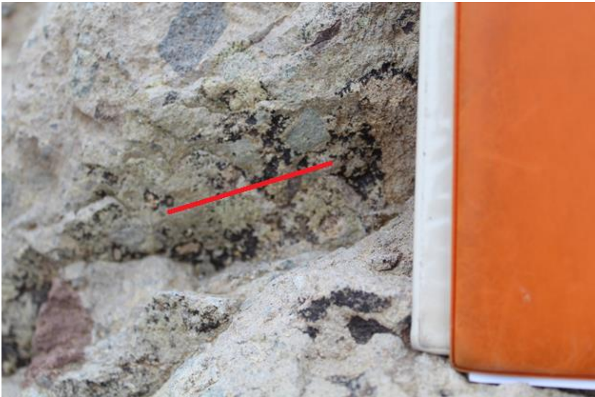
Εικόνα 254: Γράμμιση τεκτονικής ολίσθησης επιφάνειας Α.
