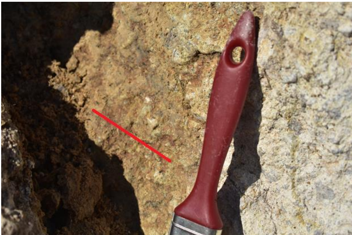
Εικόνα 79: Γράμμωση τεκτονικής ολίσθησης επιφάνειας Α.
