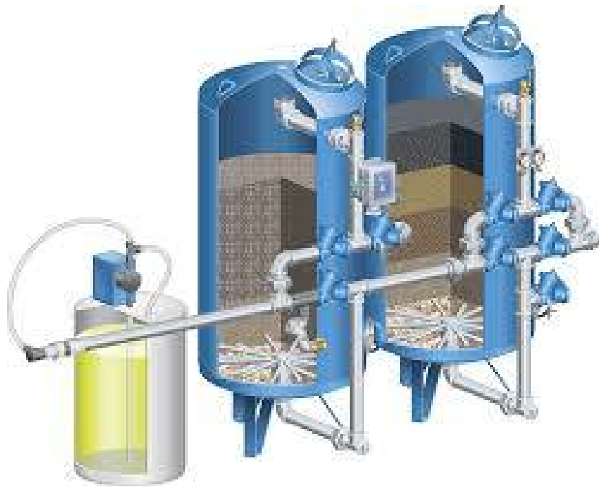
Εικόνα 4.2 Τυπική διάταξη συστήματος φίλτρανσης με προγεμισμένα φίλτρα.
