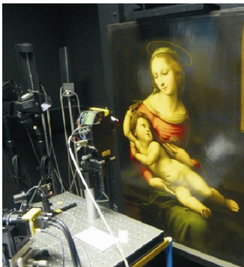
Εικόνα 2.20 2.21 Η νέα κάμερα - που αναπτύχθηκε στο Πανεπιστήμιο Nottingham Trent - επιτρέπει μια εικονική διατομή.
