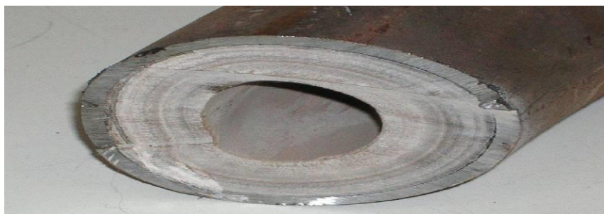
Εικ 16. Αγωγός πριν και μετά τον καθαρισμό του με «ξύστρα» (Κανακούδης, 1998).
