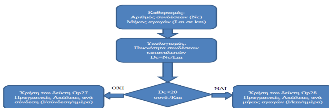
Εικόνα19 : Διαδικασία επιλογής δείκτη απόδοσης για τη λειτουργική διαχείριση των Πραγματικών Απωλειών (Farley&Trow, 2003)
