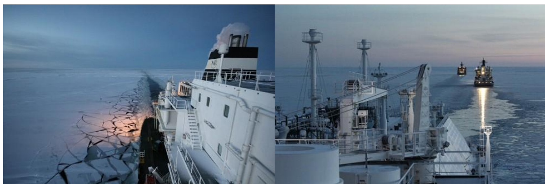
Εικόνα 3.8: Το Ob River LNG carrier διαπλέει στο NSR με τη συνοδεία παγοθραυστικών τα οποία προπορεύονται
