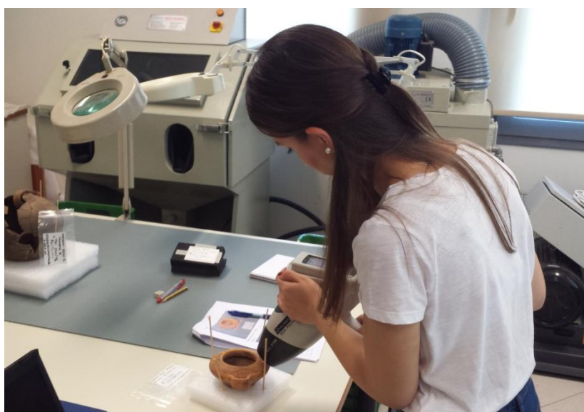
Εικόνα 39 Αναπαράσταση τυπικής διάταξης XRF.
