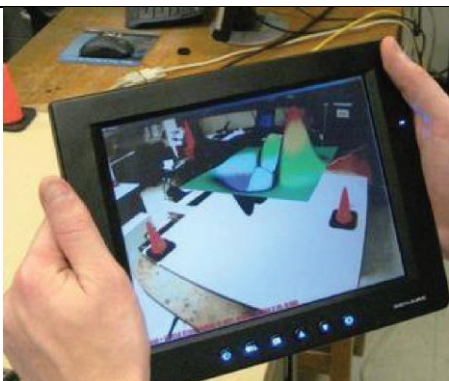
Εικόνα 7 . Ένα φορητό σύστημα AR που εμφανίζει τρισδιάστατο γράφημα (Πηγή: CSM, 2011)
