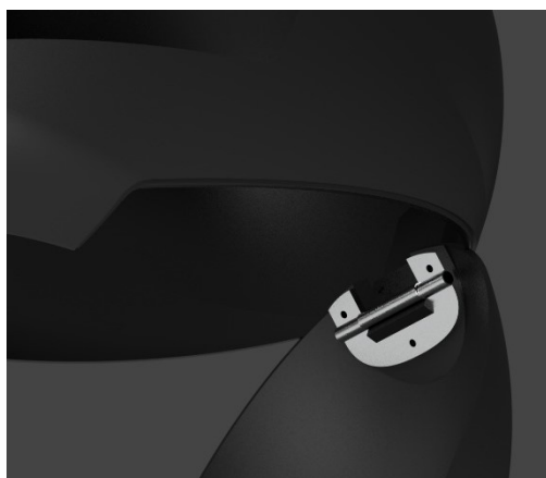
Εικόνα 62 Μηχανισμός σύνδεσης τμημάτων κελύφους δεύτερου concept.
