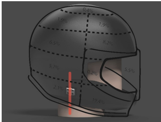
Εικόνα 89 Κατανομή συχνότερων σημείων πρόσκρουσης και πρώτο Concept.
