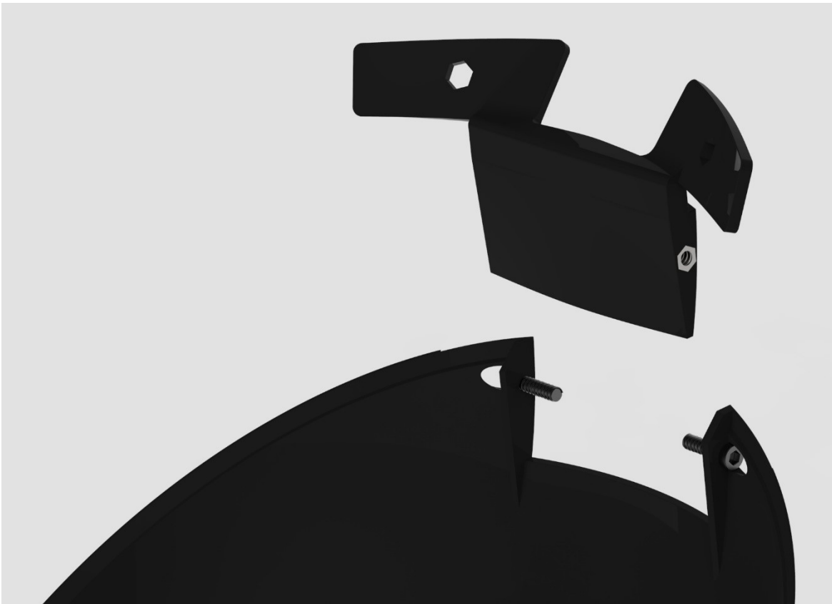
Εικόνα 98 Διαμόρφωση Κελύφους Β για την εξυπηρέτηση της στήριξης των βιδών και την περιστροφική κίνηση.
