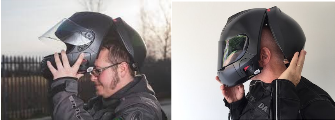
Εικόνα 29 Τοποθέτηση κράνους Vozz. Αριστερά φαίνεται η στήριξη του οπίσθιου μέρους του κράνους στο κεφάλι. Δεξιά φαίνεται η προσαρμογή του εμπρόσθιου μέρους και η μετακίνηση του οπίσθιου προς τα μπροστά για ασφάλιση.
