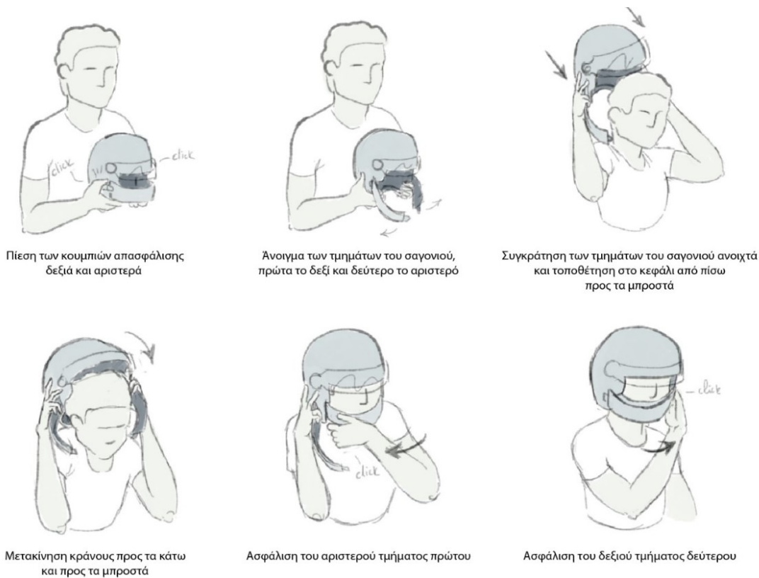
Εικόνα 54 Απεικόνιση βημάτων τοποθέτησης του Concept 1
