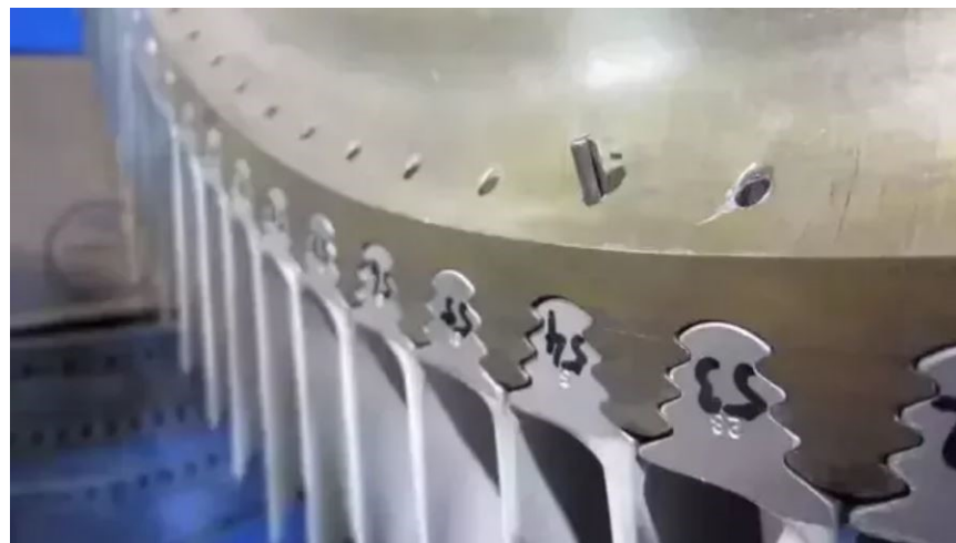
Εικόνα 56 Εφαρμογή Μηχανισμού στην ένωση λεπίδων-δίσκων στις τουρμπίνες
