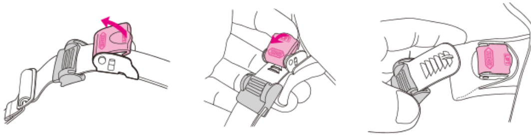
Εικόνα 10 Βήματα απελευθέρωσης οδοντωτού μικροσυστήματος ασφάλισης [Εγχειρίδιο Σωστής χρήσης SHOΕΙ]
