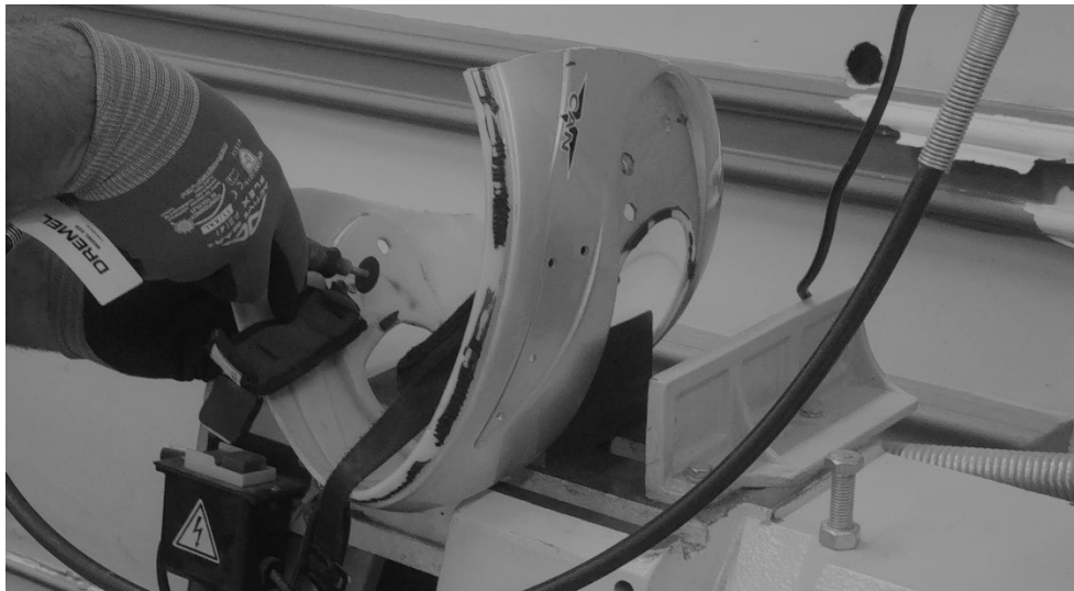
Εικόνα 78 Κόψιμο των κελυφών στις επιθυμητές γεωμετρίες
