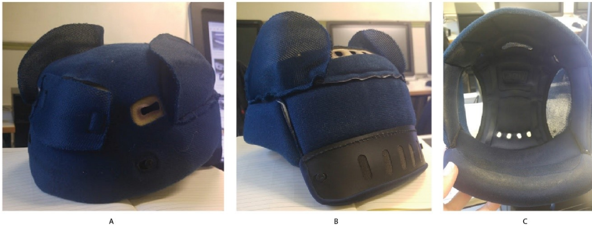
Εικόνα 5 Εσωτερική επένδυση κράνους. Α: Πλάγια-Εμπρόσθια όψη, Β: Πλάγια-Οπίσθια όψη, C: Άνοιξη
