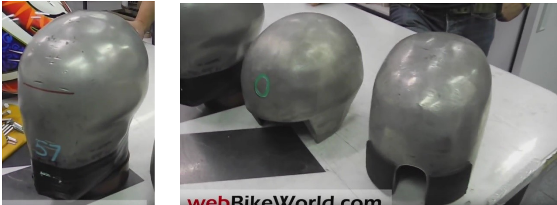
Εικόνα 44 Ομοιώματα κεφαλιού του Ευρωπαϊκού προτύπου, του Αυστραλιανού και του Αμερικανικού, αντίστοιχα
