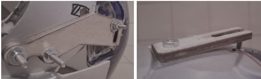
Εικόνα 87 Λεπτομέρειες του πρωτοτύπου που κατασκευάστηκαν με τη χρήση laser cutter για την εξυπηρέτηση της λειτουργικότητάς του
