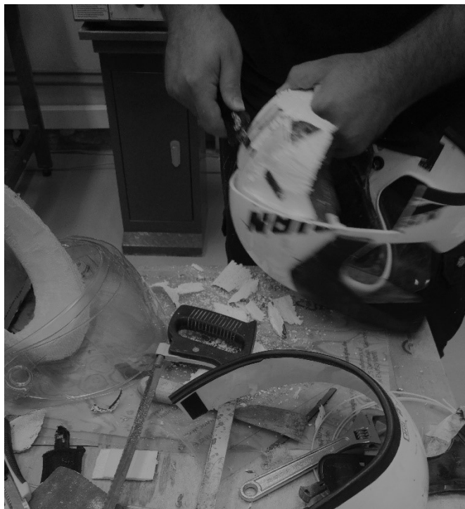
Εικόνα 81 Διαμόρφωση του προστατευτικού αφρού για την καλύτερη εφαρμογή στα κελύφη
