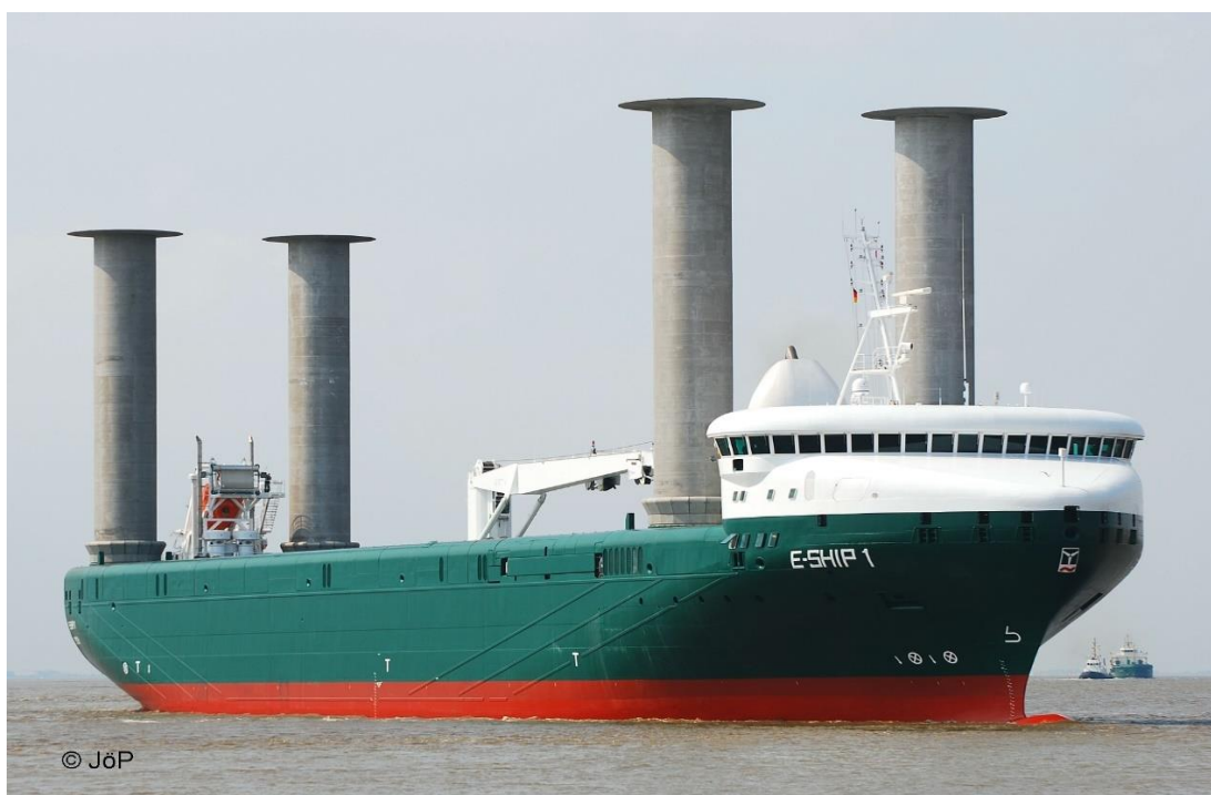
Εικόνα 7:Σύστημα πρόωσης μέσω στροφείων Flettner 40
