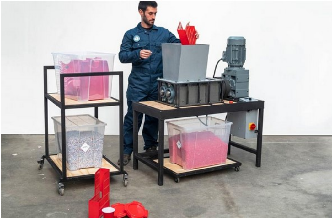
Εικόνα 6.3 – Διαδικασία θρυμματοποίησης – πηγή: https://preciousplastic.com/starterkits/showcase/shredder.html
