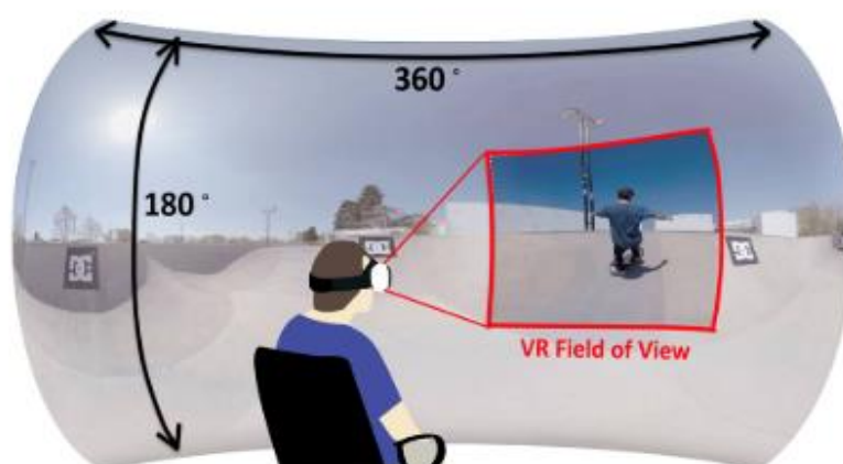
Εικόνα 3.4. Αναπαράσταση της σφαίρας προβολής βίντεο (360 ° οριζόντια και 180 ° κατακόρυφα) και του πεδίου προβολής (κόκκινο πλαίσιο) που παρατηρείται από τον θεατή χρησιμοποιώντας τη συσκευή ΕΠ (Lin et al., 2017 p. 2535)
