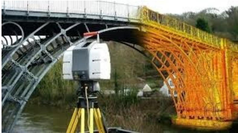
Εικόνα 9. Δημιουργία 3D με laser scanner.
