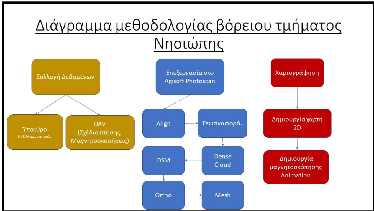
Εικόνα 1: Το διάγραμμα της μεθοδολογίας με τις εργασίες, που συντελέστηκαν ώστε να δημιουργηθεί το μοντέλο αλλά και να οπτικοποιηθεί το βόρειο τμήμα της νήσου Νησιώπης.
