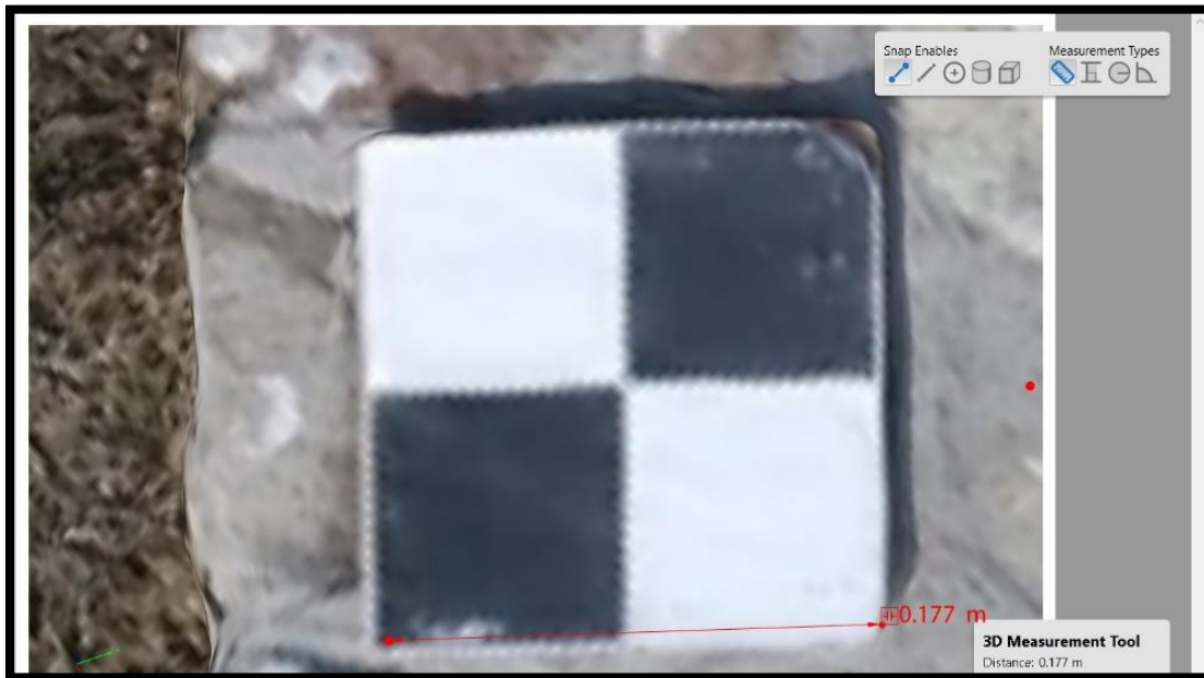
Εικόνα 37: Η μέτρηση στην πραγματικότητα είναι 0.18m ενώ στο μοντέλο που δημιουργήθηκε 0.177m.
