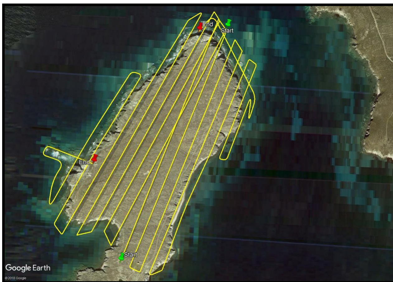
Εικόνα 3: Τα δύο σχέδια πτήσεις, που χρησιμοποιήθηκαν για τις πτήσεις πάνω από το βόρειο τμήμα της Νησιώπης. Διακρίνονται οι δύο εκκινήσεις (πινέζες με πράσινο χρώμα) αλλά και οι δύο τερματισμοί (πινέζες με κόκκινο χρώμα).
