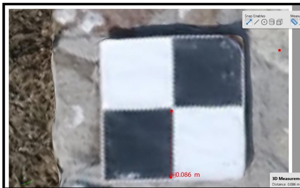
Εικόνα 326: Στη μέτρηση στο μοντέλο που δημιουργήθηκε είναι 0.086m ενώ στη πραγματικότητα 0.09m
