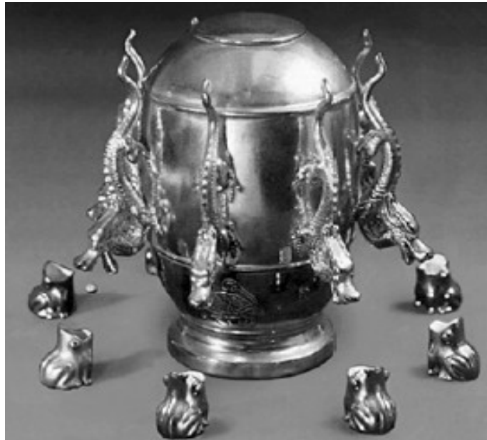
Εικόνα 2.: Το πρώτο σεισμοσκόπιο που κατασκευάστηκε το 132 μ.Χ. από τον Κινέζο φιλόσοφο Zhang Heng (78-132 μ.Χ.). Το σεισμοσκόπιο περιείχε εκκρεμές (κατακόρυφος κύλινδρος) το οποίο, αποκρινόμενο στην εδαφική δόνηση, ωθούσε μέσω μοχλών σφαιρίδια να πέσουν σε υποδοχείς (ανοιχτά στόματα βατράχων) που βρίσκονται στην βάση του.
