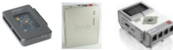
Σχήμα 5-7: Επιτρεπόμενοι controllers για την Advanced Robotics Challenge της WRO (από αριστερά προς δεξιά): MyRIO, KNR (MyRIO based), EV3 x 2
