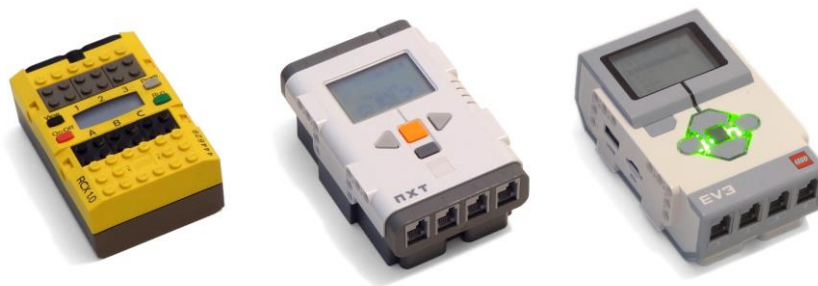
Σχήμα 2-3: Τρεις γενιές μικροεπεξεργαστών LEGO: RCX (αριστερά), NXT (μέση), EV3 (δεξιά)
