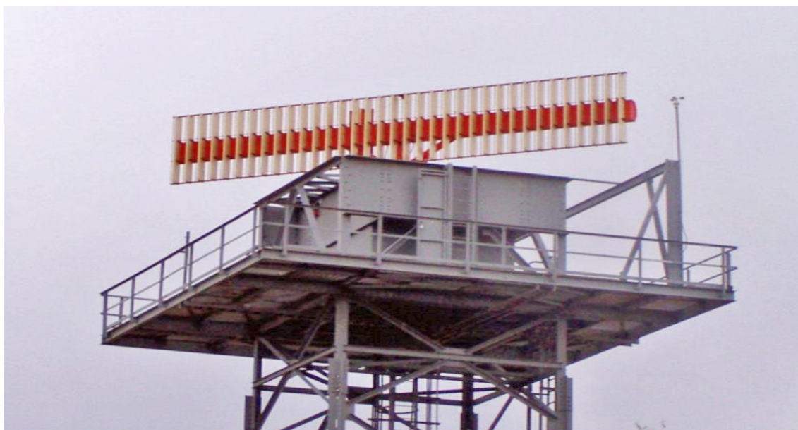
Σχήμα 3. 52: Secondary Surveillance Radar
