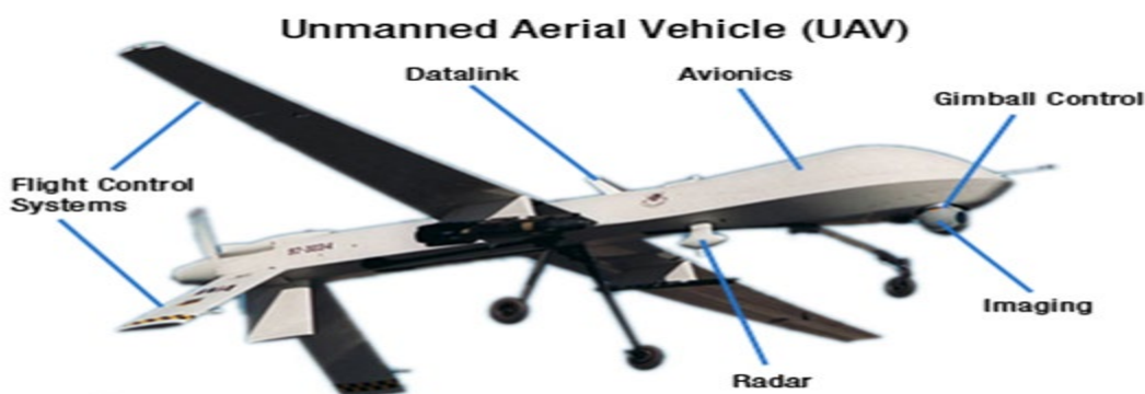
Σχήμα 2. 19: Κύρια μέρη ενός αεροχήματος
