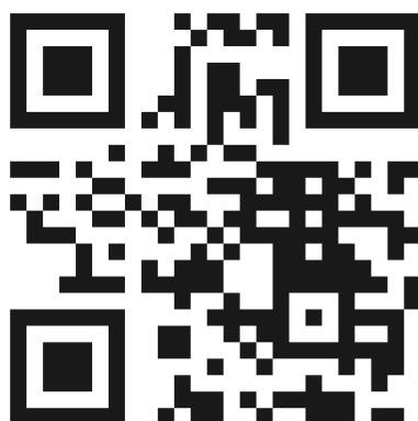
Σχήμα 2.14: Ο κώδικας QR περιλαμβάνει μοτίβο εύρεσης, διαχωριστές, χρονικά μοτίβα, μοτίβο ευθυγράμμισης και τις κωδικολέξεις δεδομένων και διόρθωσης σφαλμάτων
