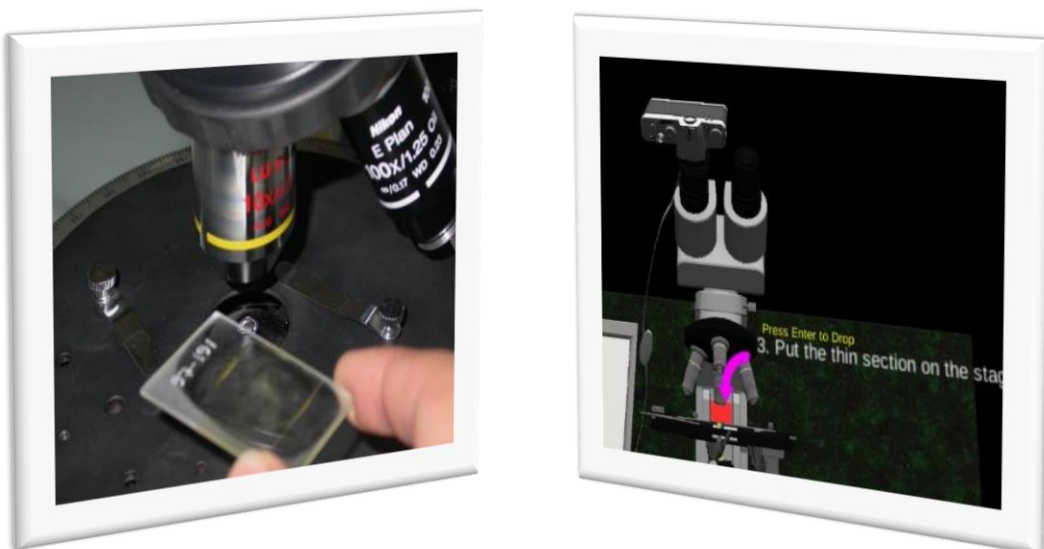
Εικόνα 3-4 Προσομοίωση της τοποθέτησης λεπτής τομής στην τράπεζα
