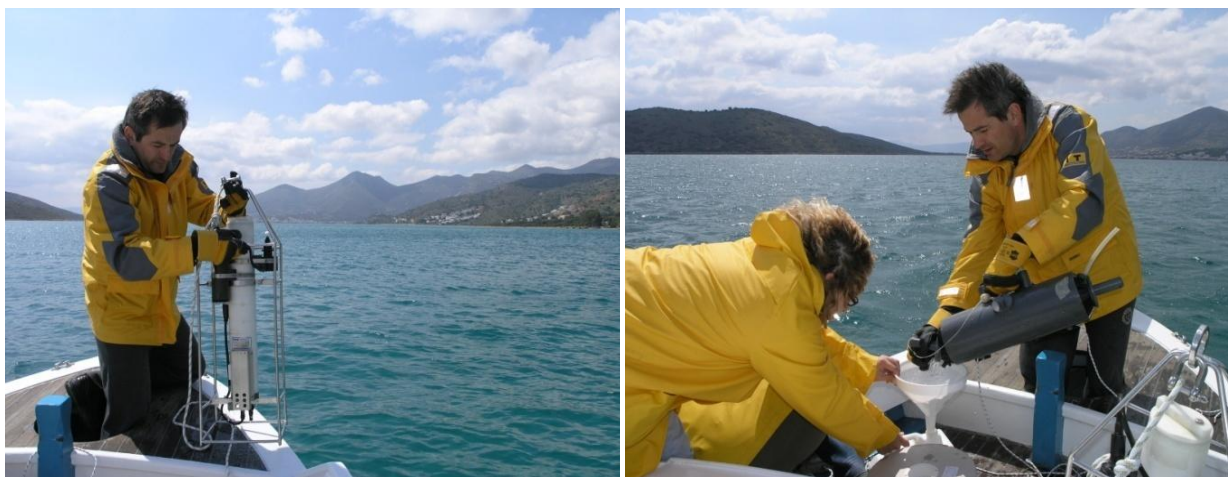
Εικ. 4. Καταγραφή υδρογραφικών παραμέτρων στην στήλη του νερού με χρήση CTD (αριστερά). Λήψη δειγμάτων νερού για την μελέτη φυσικοχημικών παραμέτρων (δεξιά).
