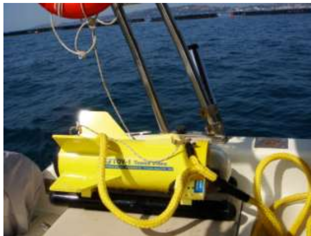
Εικόνα 2.2 Συρόμενη υποβρύχια κάμερα JW Fishers TOV-1 (φωτογραφία Ε. Σπίνος).
