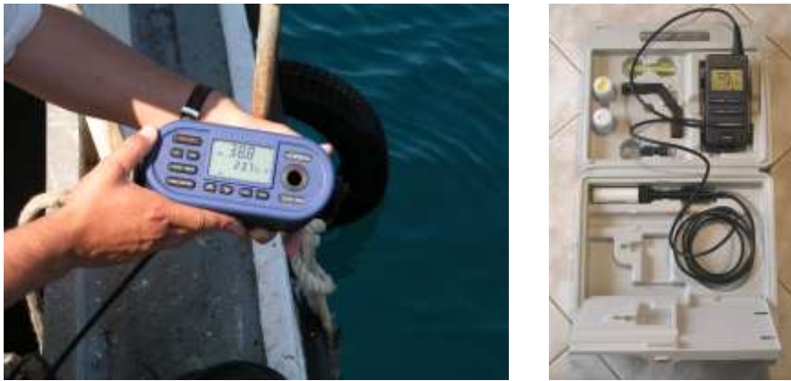
Εικόνα 2.3 Φορητά ψηφιακά όργανα με τα οποία έγινε η καταγραφή των φυσικοχημικών παραμέτρων. Αριστερά: θερμόμετρο και αλατόμετρο, δεξιά: θερμόμετρο, οξυγονόμετρο (φωτογραφίες Ε. Σπίνος).
