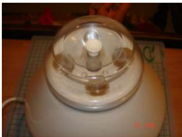
Εικόνα 3.13 Η φυγόκεντρος που χρησιμοποιήθηκε για την απομόνωση ορού του αίματος (φωτογραφία Ε. Σπίνος).
