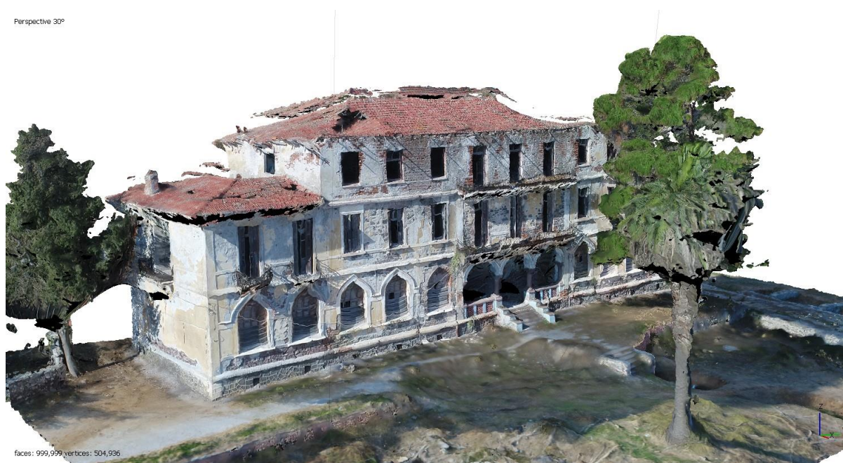
Εικόνα 17: Πολυγωνικό πλέγμα μετά την εφαρμογή της υφής
