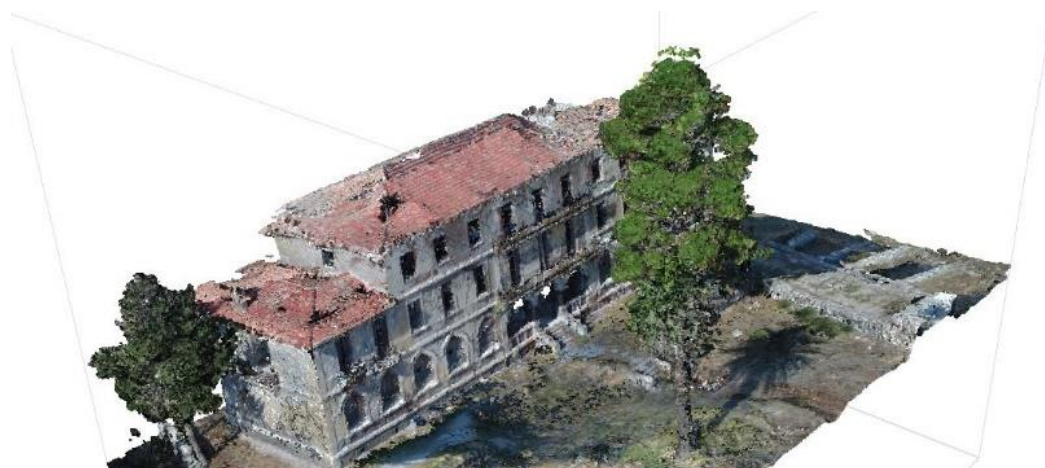
Εικόνα 15: Το πυκνό νέφος σημείων του ιστορικού μνημείου
