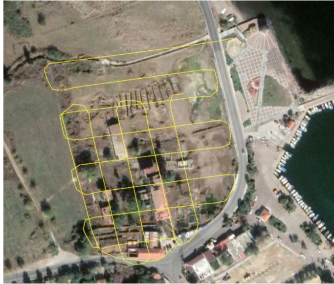
Εικόνα 9: Οπτικοποίηση της διαδρομής του flight plan για τις nadir φωτογραφίες
