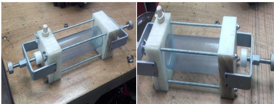
Εικόνα 35 : Κατασκευή ηλεκτρολυτικού κελιού για επίπεδα ηλεκτρόδια.
