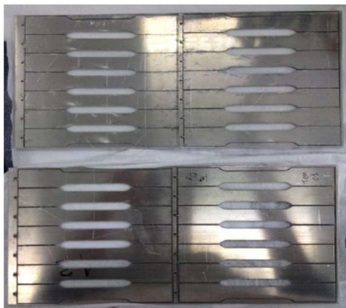
Εικόνα 40 : Κοπή δοκιμίων από πλάκα αλουμινίου.
