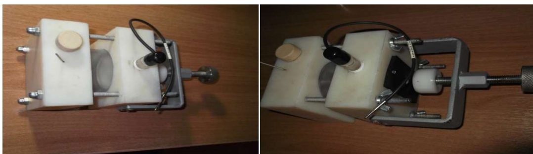
Εικόνα 36 : Κατασκευή ηλεκτρολυτικού κελιού για επίπεδα ηλεκτρόδια. Τελική μορφή με εγκατεστημένα τα ηλεκτρόδια
