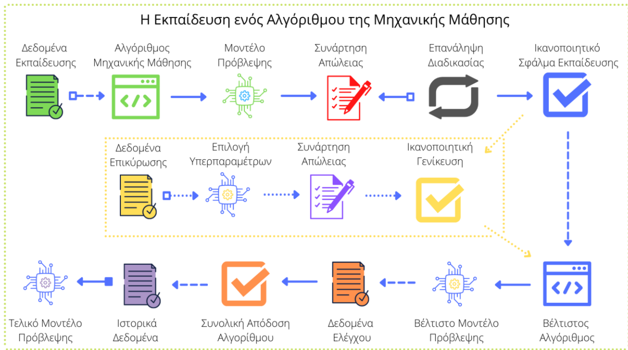
Σχήμα 4. Παρουσιάζεται η εκπαίδευση ενός αλγόριθμου της μηχανικής μάθησης. Το πρώτο βήμα της εκπαίδευσης είναι πάνω αριστερά, στα Δεδομένα Εκπαίδευσης , ενώ το τελευταίο βήμα της εκπαίδευσης είναι κάτω αριστερά, στο Τελικό Μοντέλο Πρόβλεψης , ακολουθώντας τα βέλη. Συμπεριλαμβάνεται η περίπτωση όπου επιθυμούμε την χρήση δεδομένων επικύρωσης. Ως Ιστορικά Δεδομένα , αναφέρουμε ολόκληρο το σύνολο δεδομένων, δηλαδή αυτό που περιέχει τα Δεδομένα Εκπαίδευσης , τα Δεδομένα Επικύρωσης και τα Δεδομένα Ελέγχου . Περισσότερα για την διαδικασία της επιλογής των υπερπαραμέτρων αναφέρονται παρακάτω στην ενότητα. Για την παραγωγή του σχήματος αξιοποιήθηκε η ιστοσελίδα canva.com .
