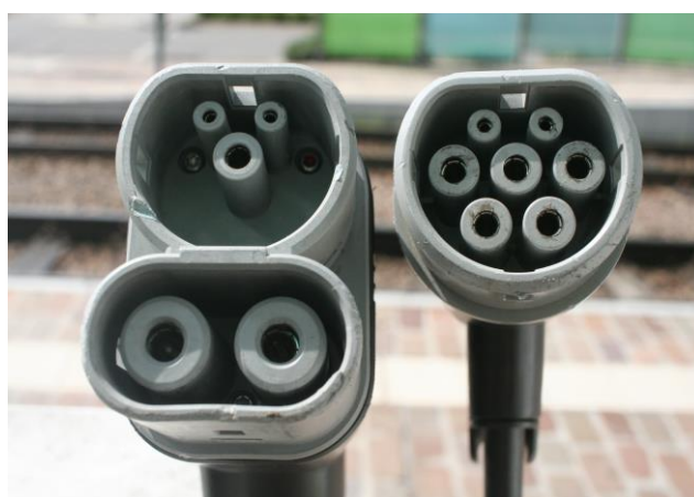
Εικόνες 1.59 – 60: IEC 62196 Type 2 Connector: Θύρα φόρτισης (αριστερά) και ρευματολήπτες CCS Combo 2 / Type 2
