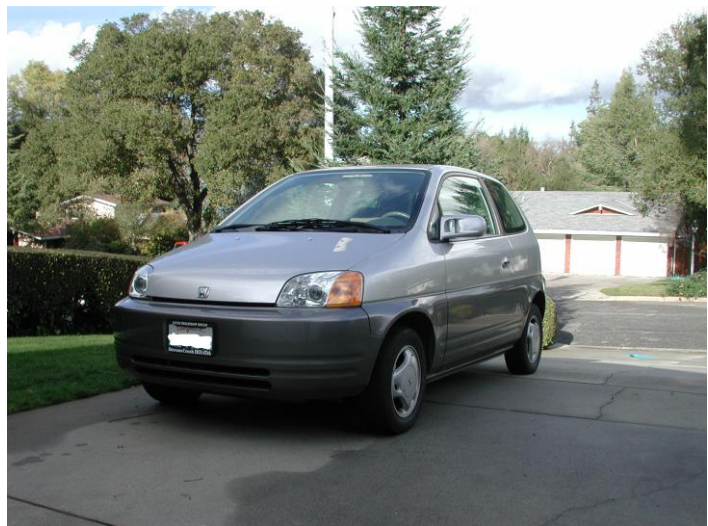
Εικόνα 3.12: 1997 Honda EV plus Το πρώτο ηλεκτρικό όχημα χωρίς μπαταρίες οξέων μολύβδου.
