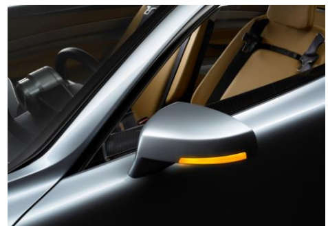
Εικόνες 4.3 - 5: Volvo 3CC: Εικόνες για τον Τύπο | Ανάπτυξη των θυρών εισόδου επιβατών – Χρήση των λαμπτήρων plasma strips στους προβολείς και στους εξωτερικούς καθρέφτες
