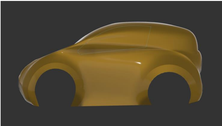
Στιγμιότυπα 5.6 – 7: Διαδικασία σχεδιασμού χώρου υαλοπινάκων Αριστερά: Προβαλλόμενη γεωμετρία αποκοπής στην ζητούμενη επιφάνεια Δεξιά: Το όχημα μετά την αφαίρεση υλικού
