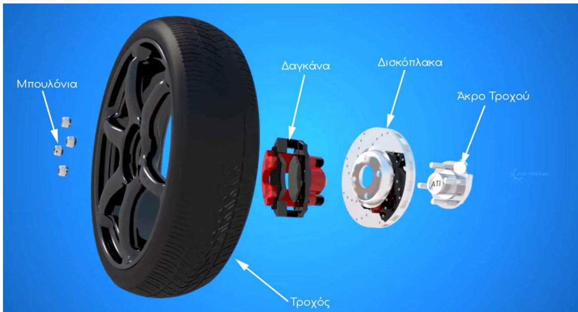
Εικόνα 1.55: Σύστημα Πέδησης με Δισκόφρενο | Exploded View (Στιγμιότυπο από το video του @Autotechlabs)
