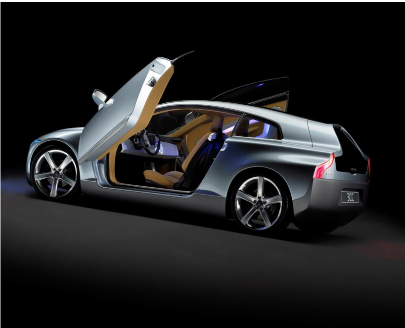
Εικόνες 4.3 - 5: Volvo 3CC: Εικόνες για τον Τύπο | Ανάπτυξη των θυρών εισόδου επιβατών – Χρήση των λαμπτήρων plasma strips στους προβολείς και στους εξωτερικούς καθρέφτες
