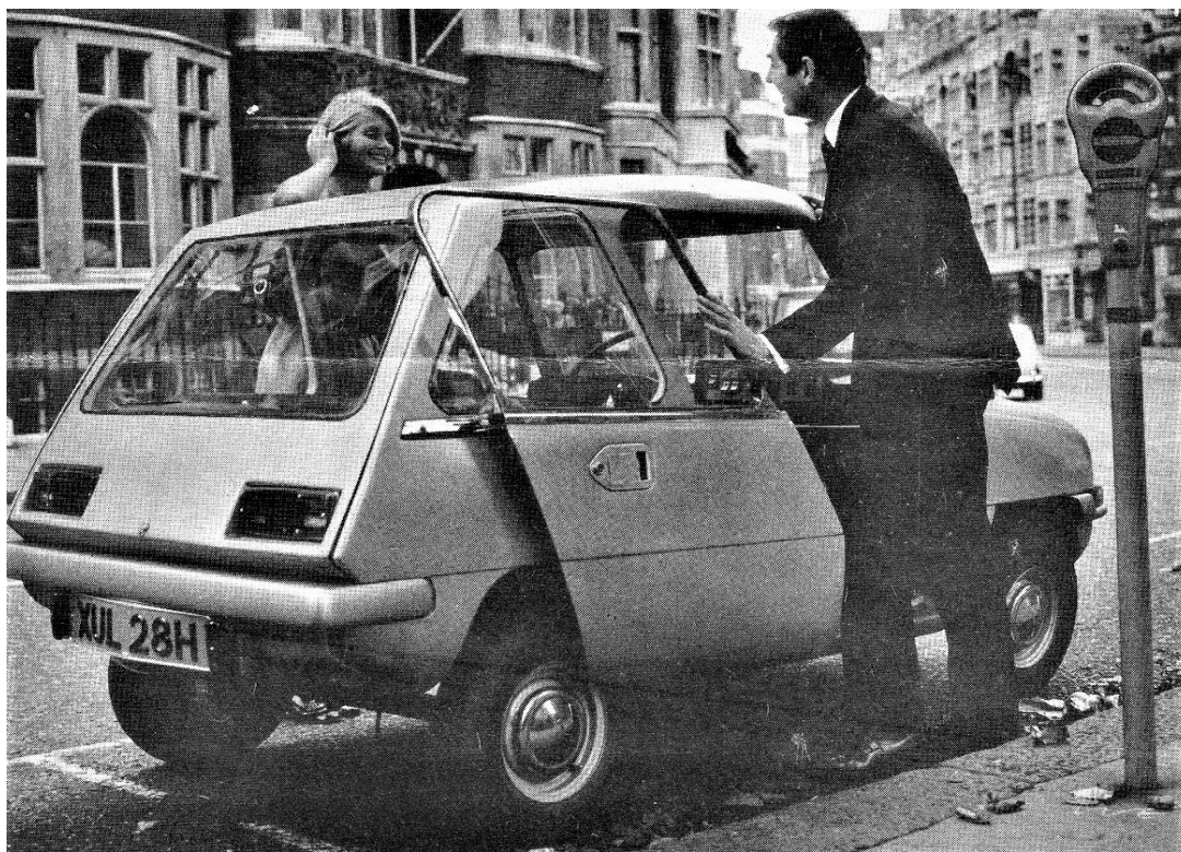
Εικόνα 2.5: Το Enfield E – 465 στους δρόμους της Αγγλίας. Το ενδιαφέρον επικεντρώνεται στην συρόμενη θύρα, αφού δημιουργεί άφθονο χώρο για την άνετη είσοδο των επιβατών, χωρίς να αυξάνει το πλάτος του οχήματος και να εμποδίζει την διερχόμενη κυκλοφορία.
