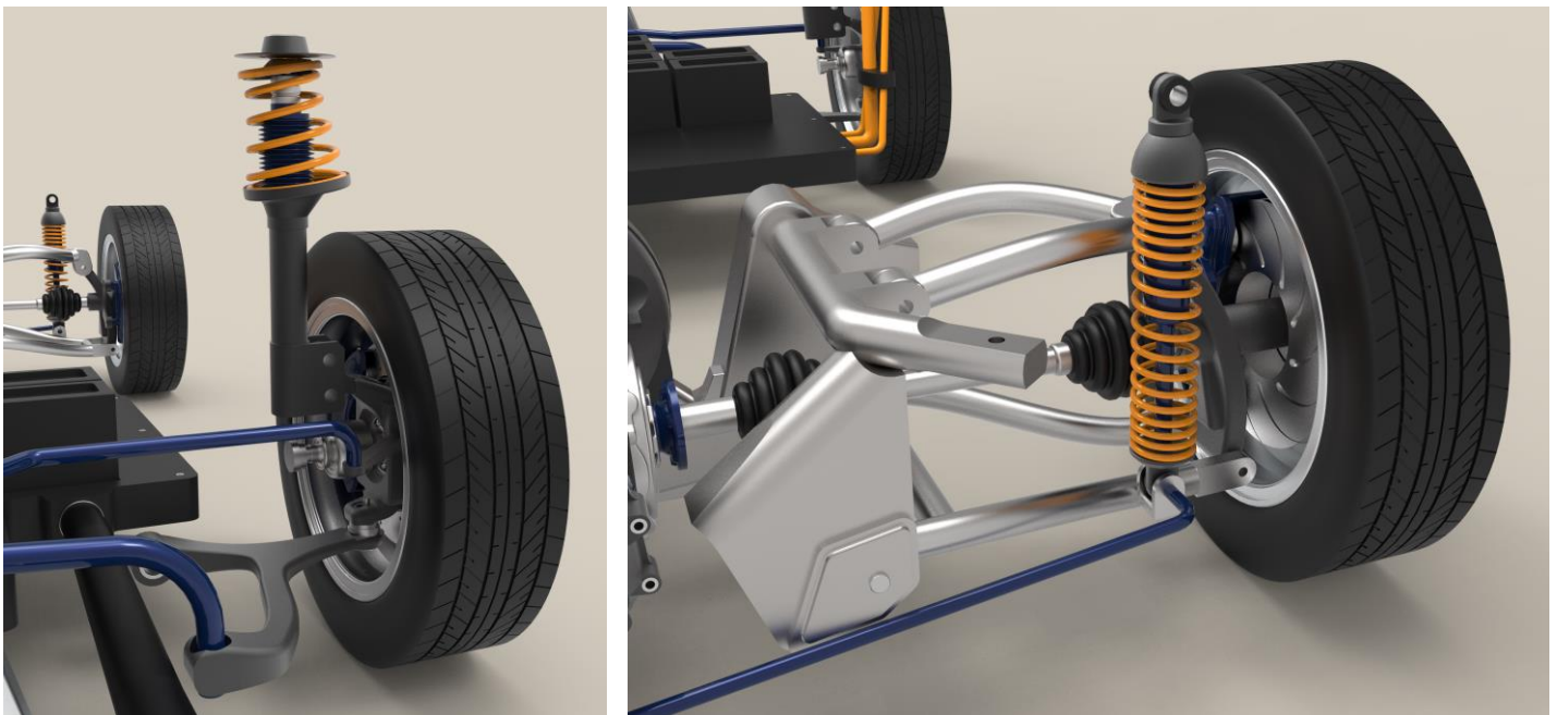
Εικόνες 5.37 – 38: Διάταξη Εμπρόσθιας Ανάρτησης (Αριστερά) και Οπίσθιας Ανάρτησης (Δεξιά) | Renderings
