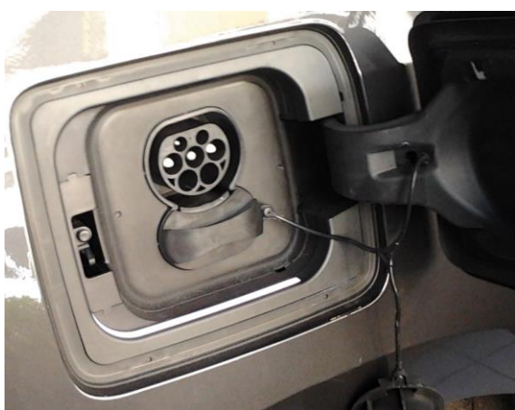
Εικόνες 1.59 – 60: IEC 62196 Type 2 Connector: Θύρα φόρτισης (αριστερά) και ρευματολήπτες CCS Combo 2 / Type 2
