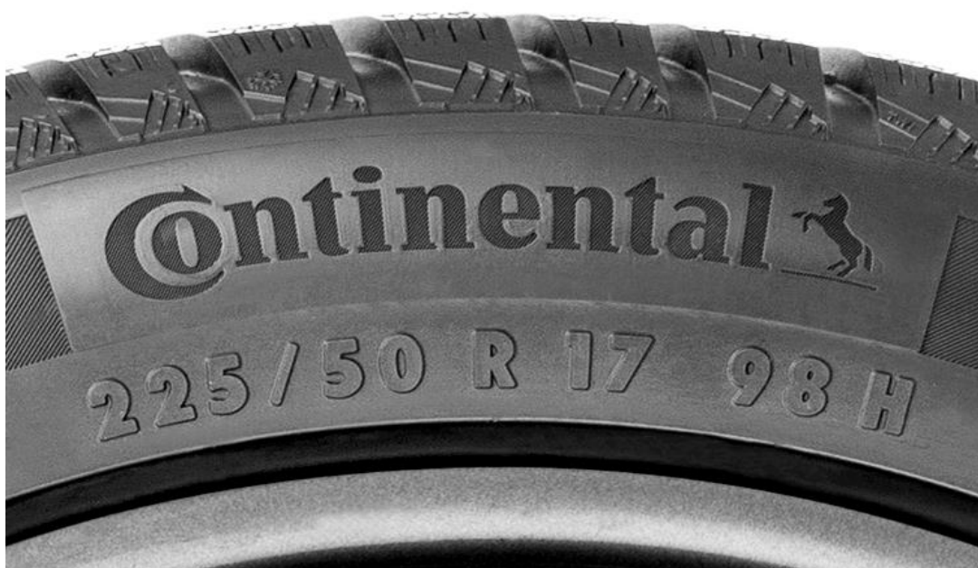
Εικόνα 1.58: Απεικόνιση Τεχνικών Χαρακτηριστικών σε ένα ελαστικό
