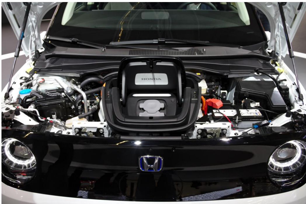
Εικόνα 4.38: Το Honda e παρέχει πρόσβαση σε χρήσιμα ηλεκτρονικά συστήματα μέσω του καπό στο εμπρός μέρος του | I.A.A. Frankfurt 2019
