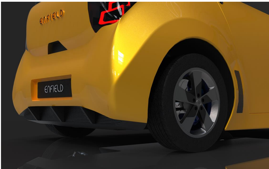
Εικόνα 5.23: Διαχύτης Οπίσθιου Προφυλακτήρα & Αεραγωγός στον όλο του τροχού / Rendering – Λεπτομέρεια
