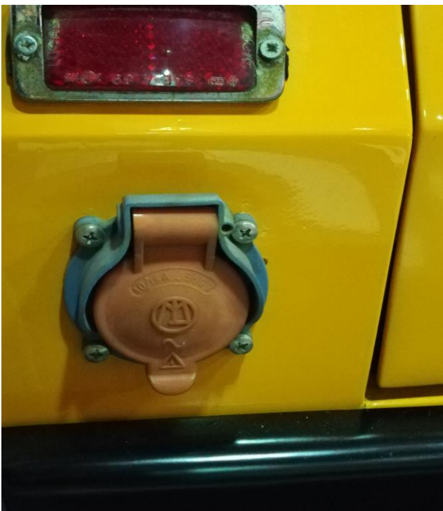
Εικόνα 2.12: Η εξωτερική θύρα φόρτισης του E – 8000 Φωτό: Μάιος 2019 - Λεπτομέρεια
