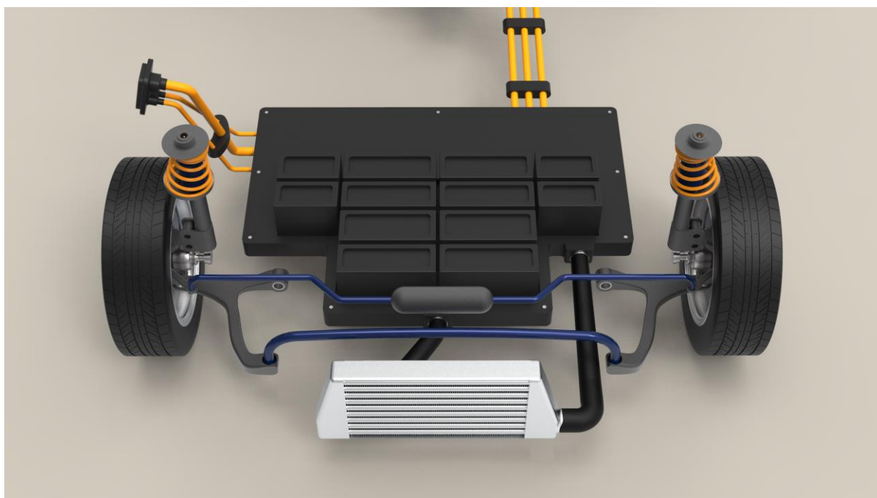
Εικόνα 5.35: Διάταξη εμπρός άξονα: Σύστημα Ψύξης, Διεύθυνσης, Ανάρτησης και Συστοιχία Μπαταριών (Rendering)
