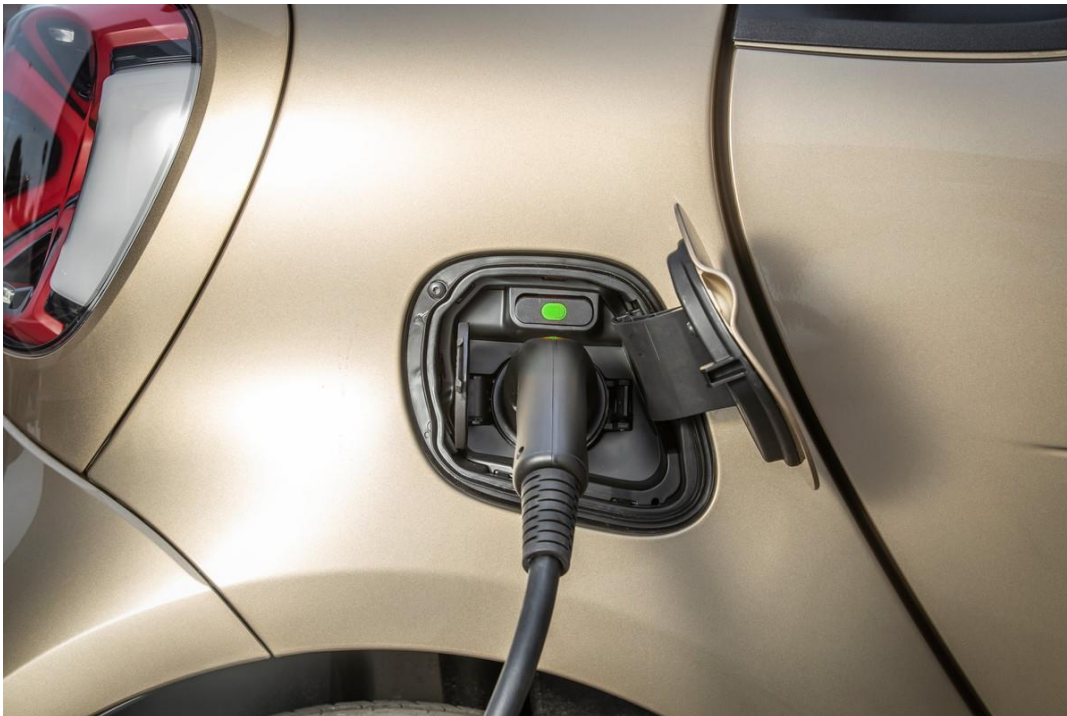
Εικόνα 4.42: Λεπτομέρεια στο smart EQ fortwo | Θύρα Φόρτισης μέσω ρευματολήπτη Type 2
