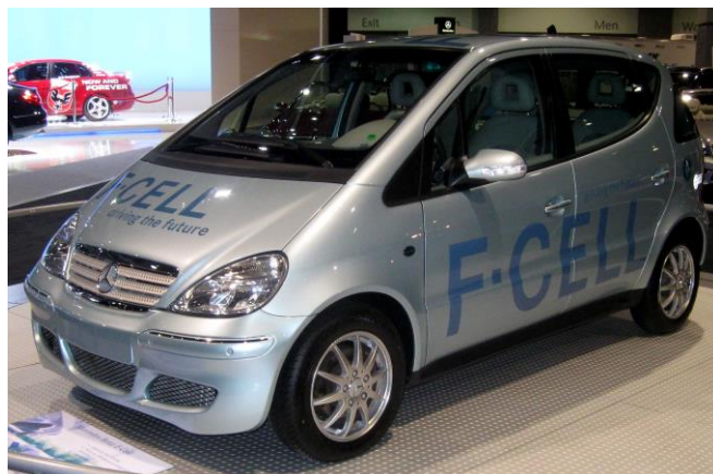
Εικόνα 3.15: 2005 Mercedes A Class Fuel Cell | Βασισμένο στην πλατφόρμα του Μοντέλου A Class, το powertrain περιλαμβάνει ηλεκτρικό κινητήρα με κυψέλες υδρογόνου για υψηλή αυτονομία
