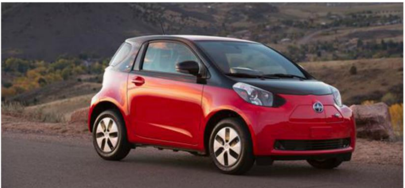
Εικόνες 4.14: 2013 Scion iQ EV /Όχημα Παραγωγής στις Η.Π.Α. Με εξαίρεση τα διαφορετικά λογότυπα, το Scion iQ EV μοιράζεται κοινή πλατφόρμα και αμάξωμα με το αντίστοιχο Toyota eQ.
