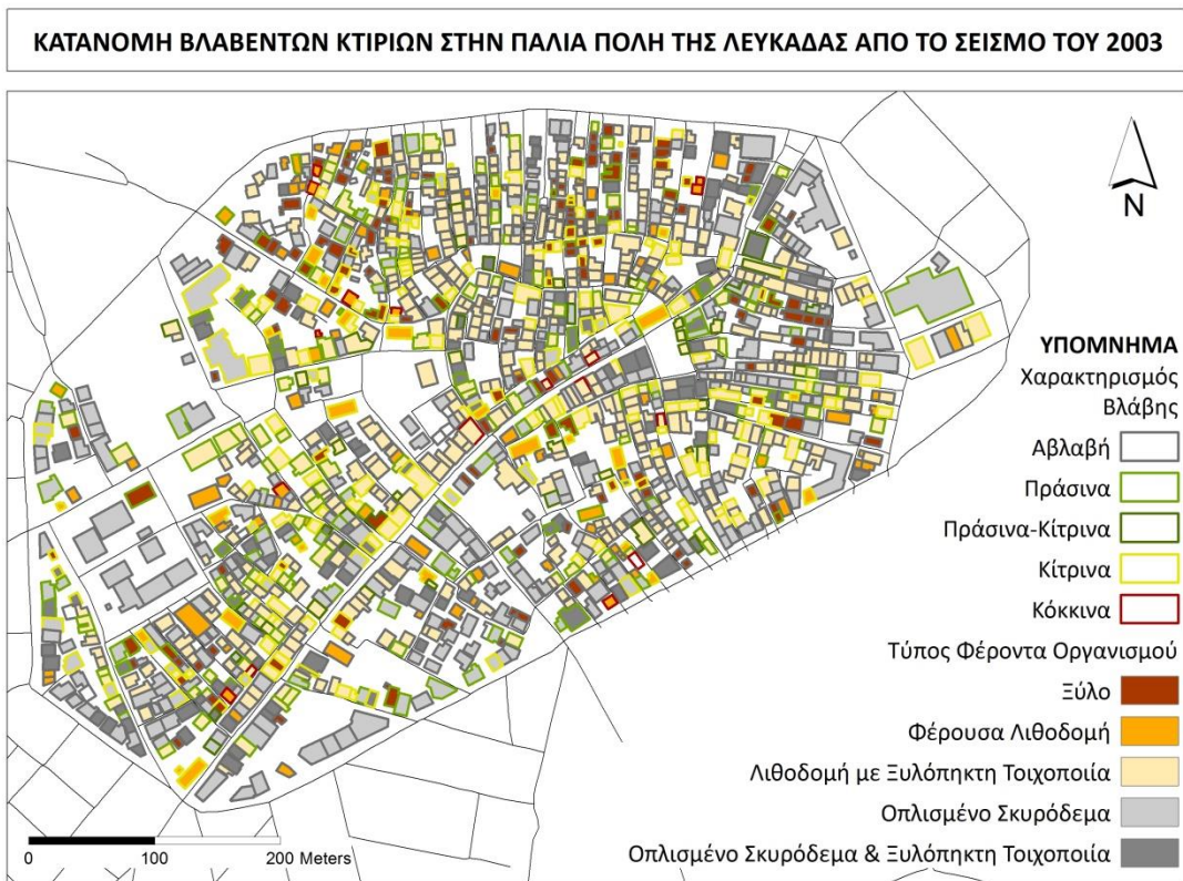
Εικόνα 8.5. Κατανομή βλαβέντων κτιρίων με βάση το είδος του φέροντα οργανισμού και το βαθμό βλάβης στην παλιά πόλη της Λευκάδας από το σεισμό του 2003.
