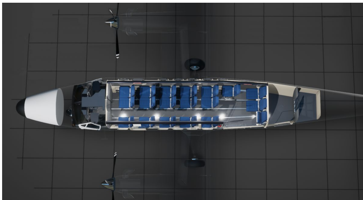
Εικόνα 3.6 Φωτορεαλιστική απεικόνιση της διάταξης των 19 θέσεων της βασικής σχεδίασης του Twin Otter DHC-600. Πηγή: (Viking Air Ltd, 2021)
