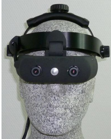
Εικόνα 6. Σύστημα προβολής δια μέσου συσκευής βίντεο προσαρμοσμένης στο κεφάλι του χρήστη (Trivisio, 2011)
