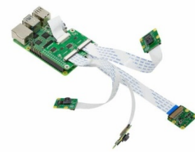
Σχήμα 18: Raspberry Pi multiCamera adapter module
