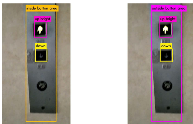
Σχήμα 5: Αναγνώριση του εξωτερικού πίνακα και των κουμπιών με διαχωρισμό των φωτεινών από τα μη φωτεινά
