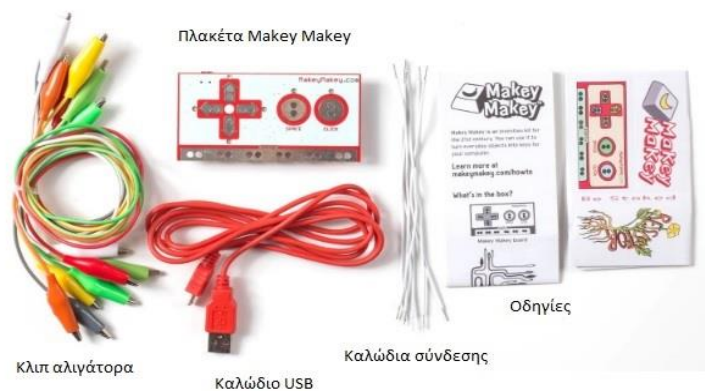
Εικόνα 3.4 Τα περιεχόμενα της βασικής έκδοσης του Makey Makey.
