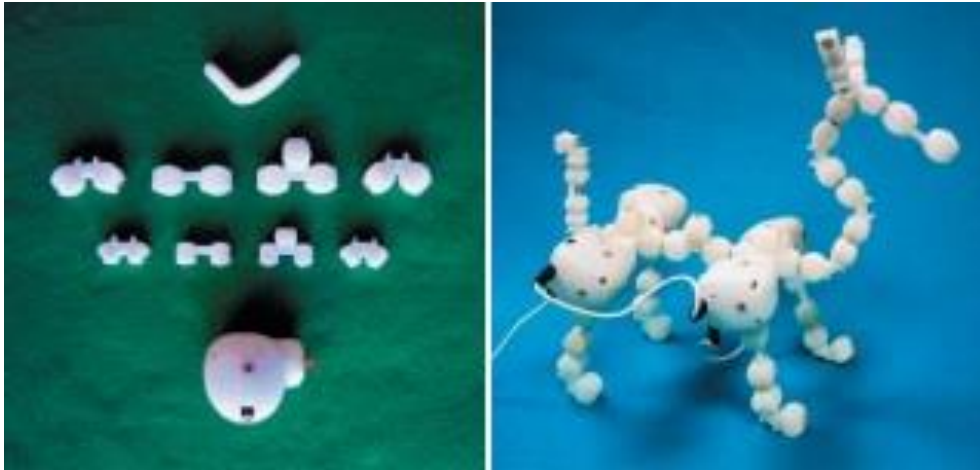
Εικόνα 3.2 Το Torobo αποτελείται από στατικά και μηχανοκίνητα εξαρτήματα (αριστερά), τα οποία καθώς συνδυάζονται μπορούν να κατασκευάσουν βιομορφικές μορφές (δεξιά) με κινητική μνήμη. Πηγή: Raffle, H. S., Parkes, A. J., & Ishii, H. (2004, April). Torobo: a constructive assembly system with kinetic memory. Proceedings of the SIGCHI conference on Human factors in computing systems , 647-654.
