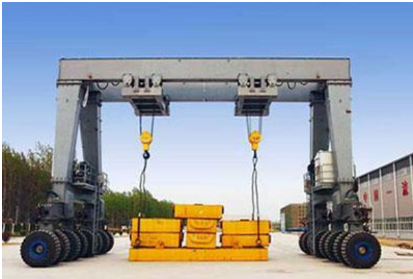
Εικόνα 2.1: Γερανός Rubber Tired Gantry Crane (RTG).
