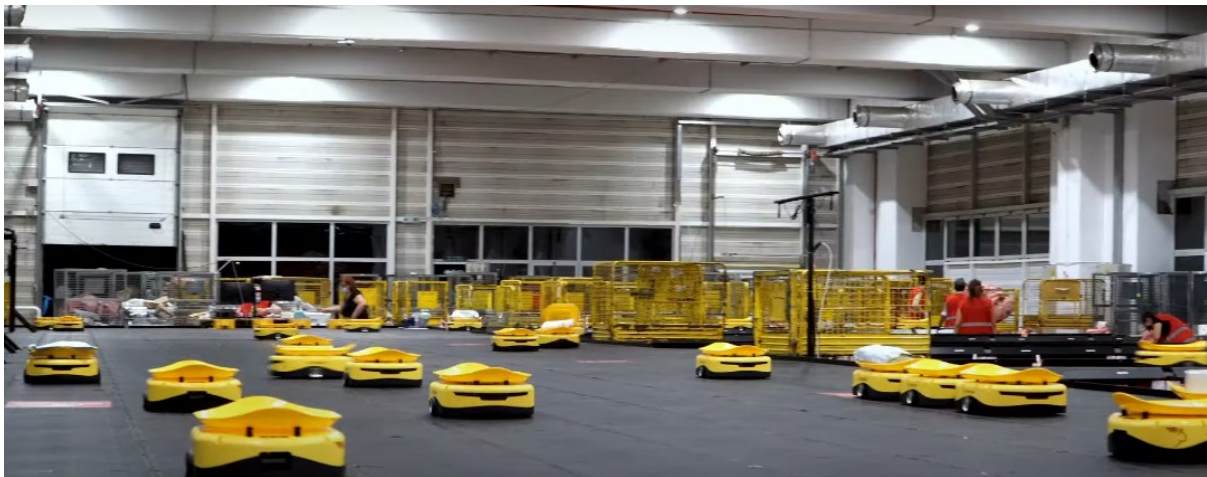
Εικόνα 5.5 Χρήση των ρομπότ σε αποθήκη στα ΕΛΤΑ (Elta-courier, 2021)
