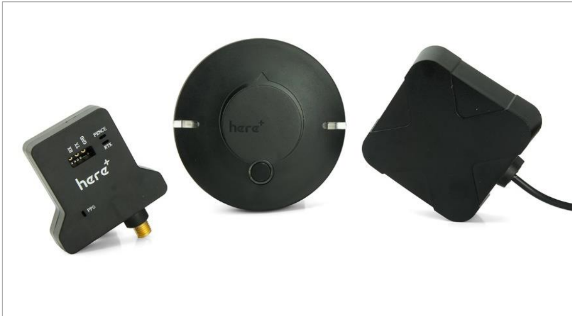
Εικόνα 13 Του ζεύγους δεκτών GPS Here+, αριστερά ο δέκτης εδάφους(base), στο κέντρο ο δέκτης του αεροσκάφους με την ενσωματωμένη κεραία(Rover) και δεξιά η εξωτερική κεραία του Δέκτη βάσης
