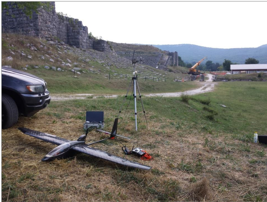
Σχήμα 14 Πεδίο δοκιμών πτήσεως με εγκατάσταση του σταθμού εδάφους και της τηλεμετρίας
