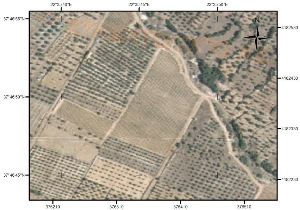
Εικόνα 88 Ορθοφωτοχάρτης, Κτηματολόγιο ΑΕ, (2009). Μέγεθος εικονοστοιχείου: 0,50m
