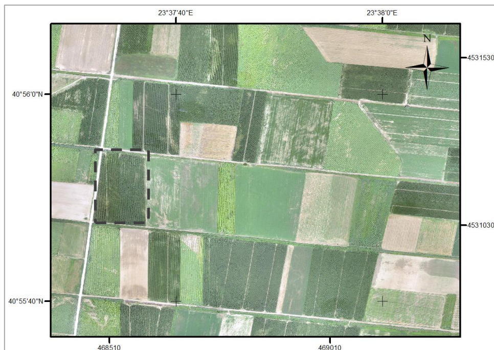
Εικόνα 63 Ορθομωσαϊκό από φωτοληψίες 05/07/2016 με δέκτη Canon ixus 160 και αλληλεπίθεση κοντινού υπέρυθρου φάσματος maxmax Canon ixus. (μέγεθος εικονοστοιχείου 5,69cm. /ύψος πτήσης 262μ),(περίγραμμα λεπτομέρειας)
