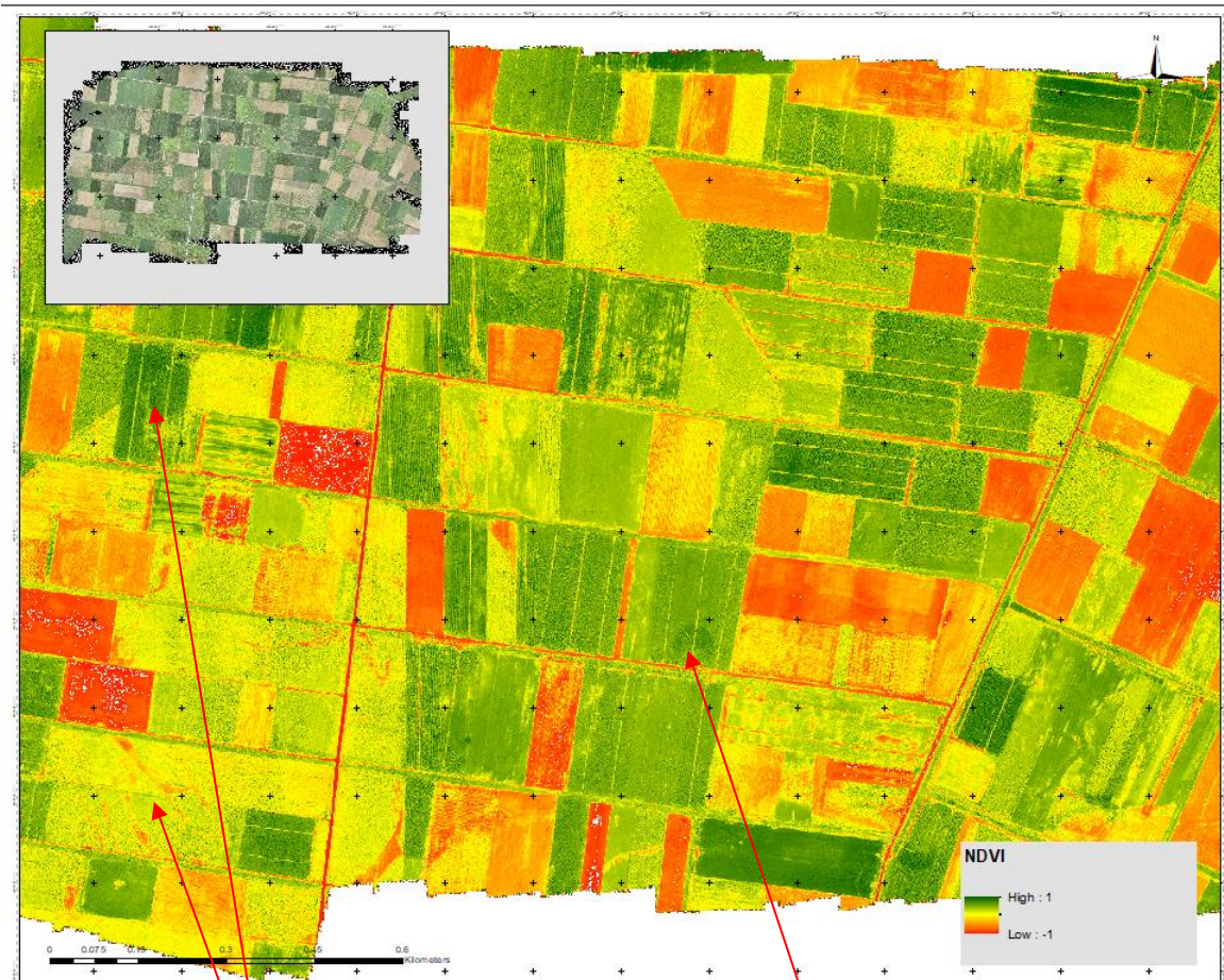
Εικόνα 100 Αποτέλεσμα υπολογισμού δείκτη βλάστησης από τις μάντες: Red, της Canon IXUS 160 και NIR της MaxMax Canon IXUS 160(καλλιέργειες Καλαμπόκι, Σόργο)
