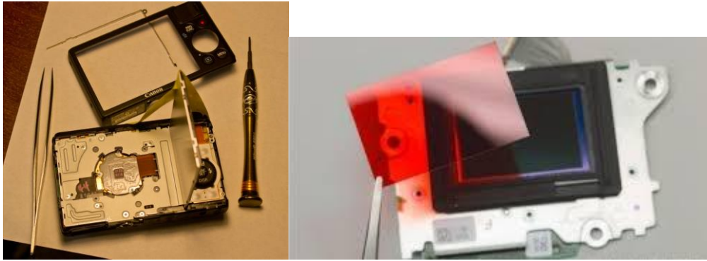
Εικόνα 9 Αποσυναρμολόγηση φωτογραφικής μηχανής Point & Shoot και αλλαγή του φίλτρου φάσματος
