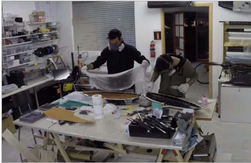
Εικόνα 40 Επίστρωση των υλικών κατασκευής σε μορφή Sandwich (Carbon Fiber, Aramid Honeycomb, Carbon Fiber) στο καλούπι κατασκευής και εμποτισμός με εποξειδική ρητίνη
