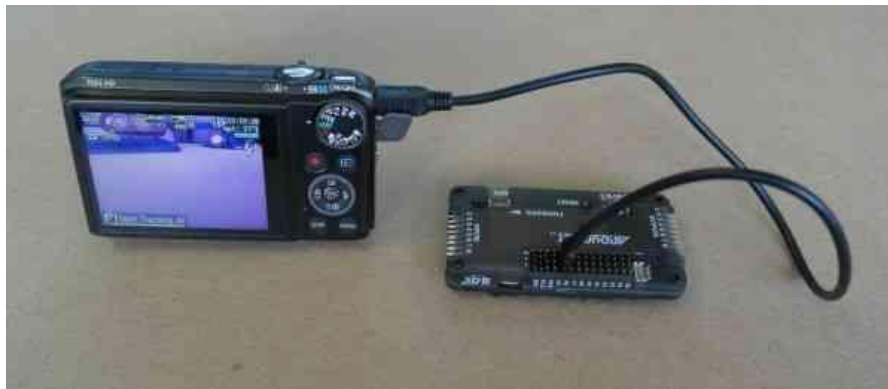
Εικόνα 6 Το καλώδιο και η διασύνδεση της μονάδας αυτόματου πιλότου με την κάμερα canon ixus 160
