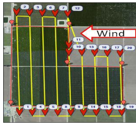
Εικόνα 51 Εσφαλμένος (αριστερά) και σωστός (δεξιά) προσανατολισμός διαδρομών πτήσεως σε σχέση με τον επικρατούντα άνεμο
