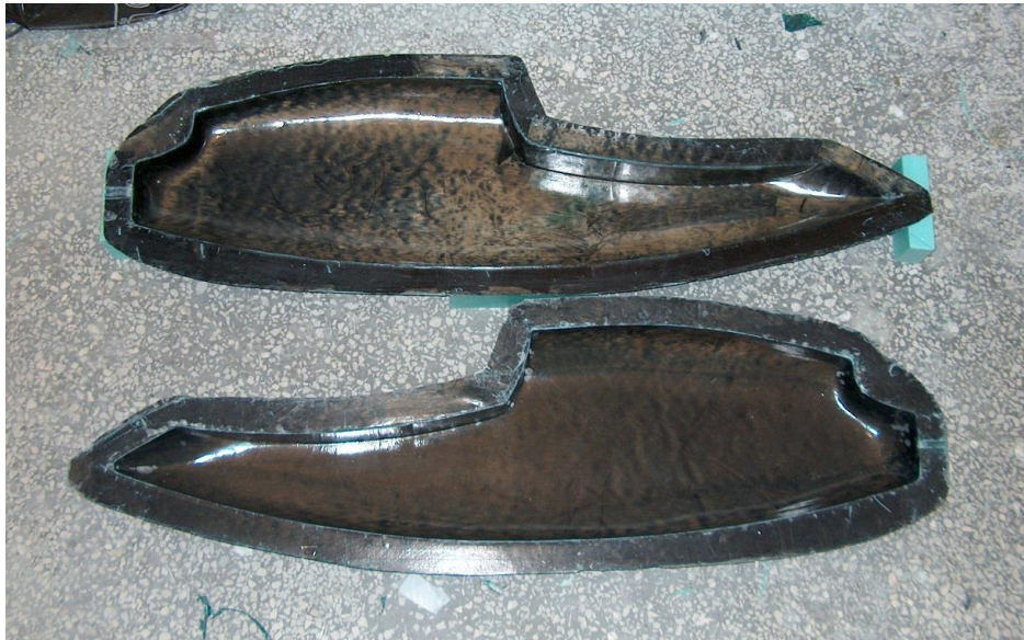
Εικόνα 39 Αποτέλεσμα αρνητικού καλουπιού (μήτρας) της ατράκτου
