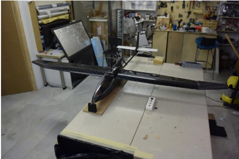
Εικόνα 47 Τελική συναρμολόγηση του αεροχήματος Φορέας
