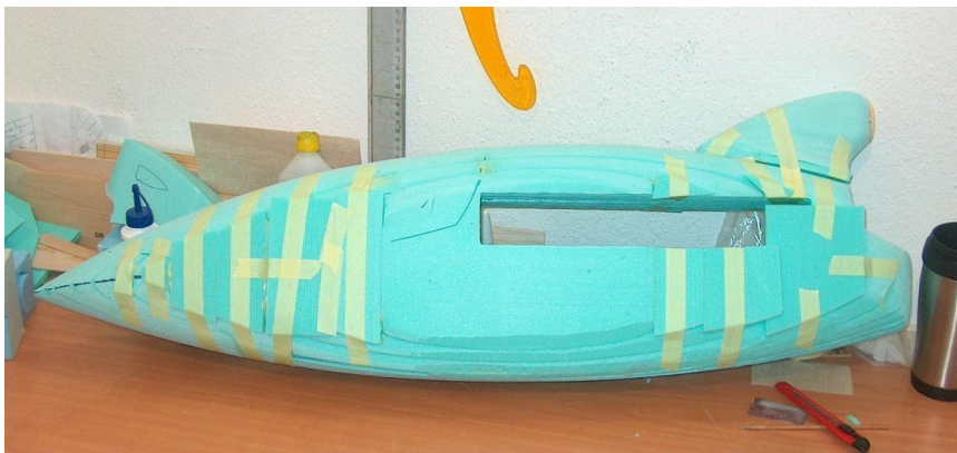
Εικόνα 37 Συγκόλληση των τομών διογκωμένης πολυστερίνης και δημιουργία προτύπου της άτρακτου
