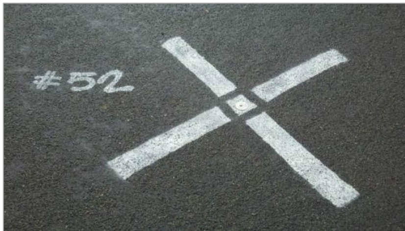
Εικόνα 54 Σήμανση φωτοσταθερού σημείου με χρήση μπογιάς (Spray)
