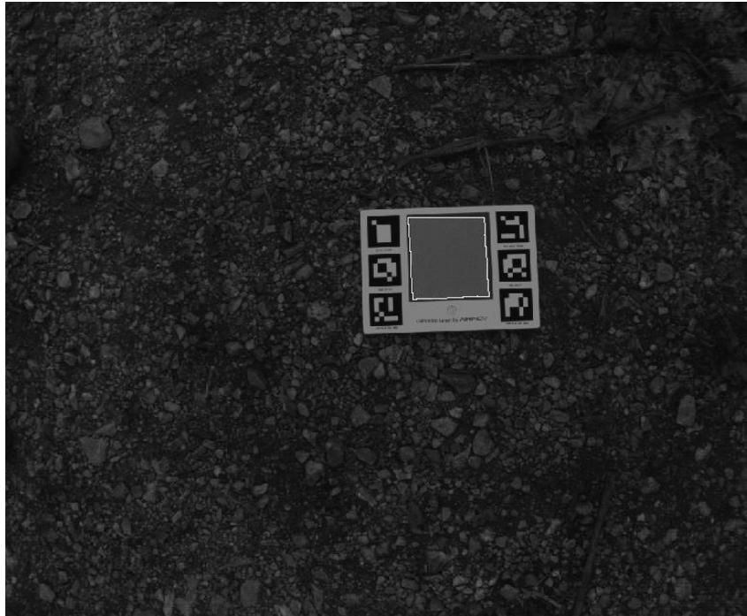
Εικόνα 82 Δείγμα στόχου Albedo, πριν την καταγραφή. Τιμές: Green: 18.9%, Red: 20.1%, Red Edge: 22.7%, NIR: 26%.
