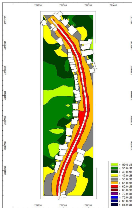
Χάρτης θορύβου 4 β : βάση της μέτρησης των Decibel και τους υπολογισμούς του λογισμικού CadnaA.
