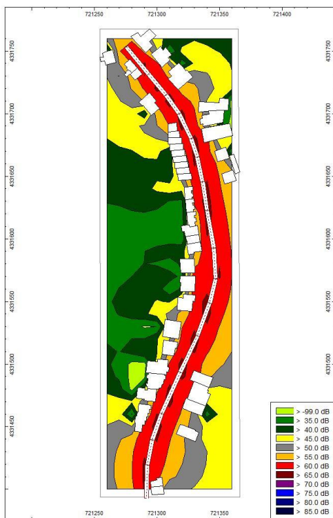
Χάρτης θορύβου 3 β : βάση της μέτρησης των Decibel και τους υπολογισμούς του λογισμικού CadnaA.
