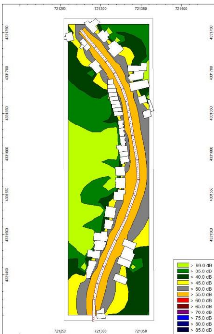
Χάρτης θορύβου 2 β : βάση της μέτρησης των Decibel και τους υπολογισμούς του λογισμικού CadnaA.
