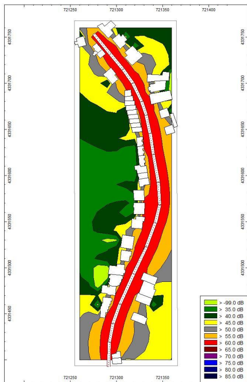
Χάρτης θορύβου 1 β : βάση της μέτρησης των Decibel και τους υπολογισμούς του λογισμικού CadnaA.
