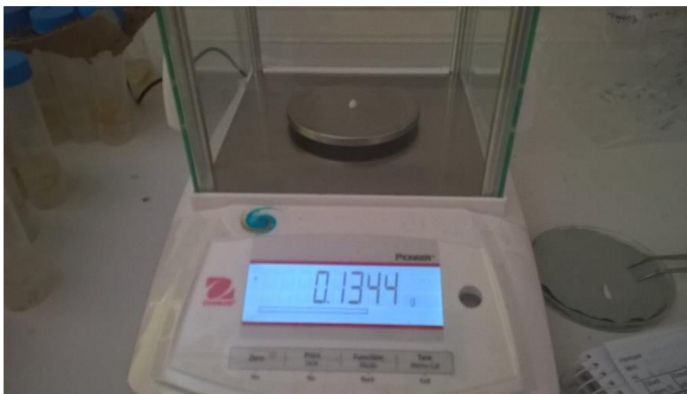
Φωτογραφία 2-4 Ζύγισμα ωτόλιθων του είδους Micromesistius routassou σε ζυγό ακριβείας Pioneer με ακρίβεια (0,0001).
