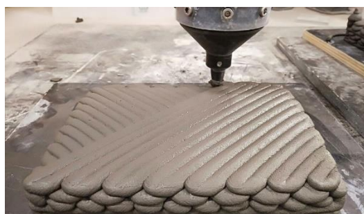
Εικόνα 31 Τρισδιάστατη εκτύπωση δομής Bouligand με σκυρόδεμα, εμπνευσμένο απ' το κέλυφος του αμερικάνικου αστακού. Ανακτήθηκε από https://www.theconstructionindex.co.uk/news/view/lobster-shells-inspire-stronger-3d-printed-concrete .
