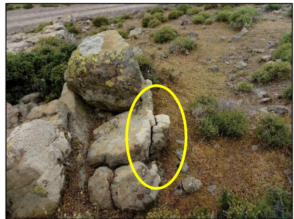
Εικόνα 43 Γραμμική εμφάνιση διαρρήξεων επί βράχου (Δ)
