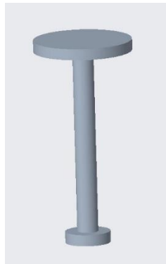
Εικόνα 61: Έμβολο σχεδιασμένου αποσβεστήρα.
