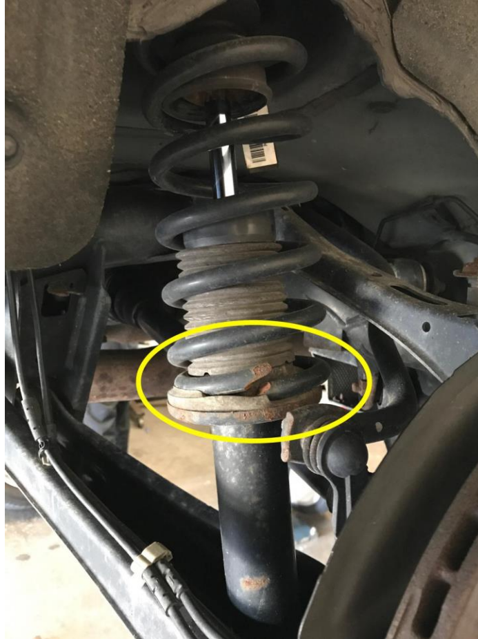
Εικόνα 30: Σπασμένο ελατήριο μετά από κακή χρήση και συντήρηση
