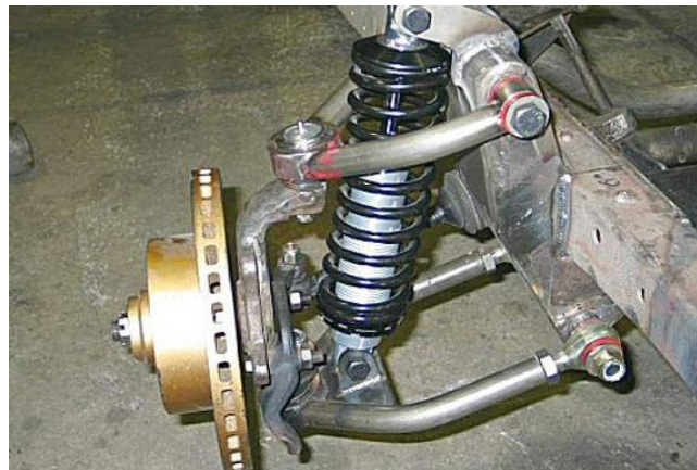
Εικόνα 12: Εγκατεστημένη ανάρτηση διπλών ψαλιδιών.
