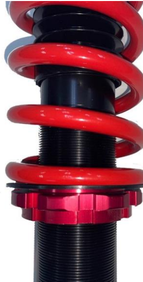
Εικόνα 27: Αποσβεστήρας με σπείρωμα, για την ρύθμιση ύψους του ελατηρίου.
