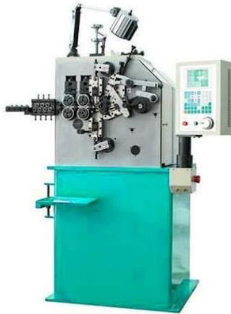
Εικόνα 31: Μηχάνημα ψυχρής περιέλιξης για κατασκευή ελατηρίου.
