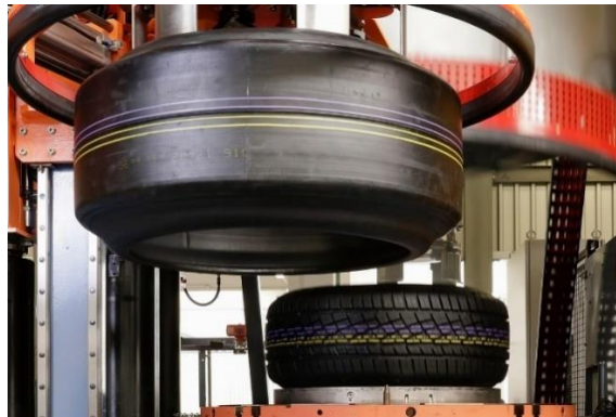
Εικόνα 16: Μέρος διαδικασίας κατασκευής ελαστικών με τύμπανο ζώνης.
