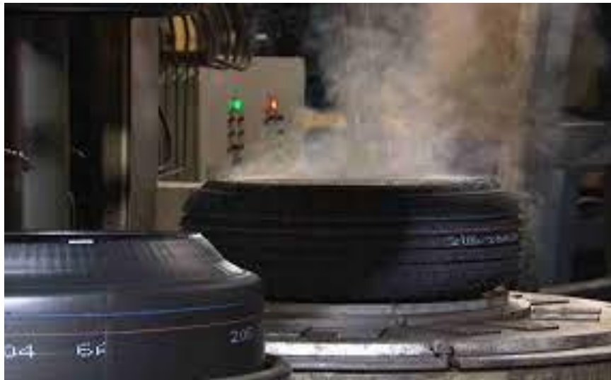
Εικόνα 17: Μέρος της διαδικασίας ψύξης στην κατασκευή ελαστικών.
