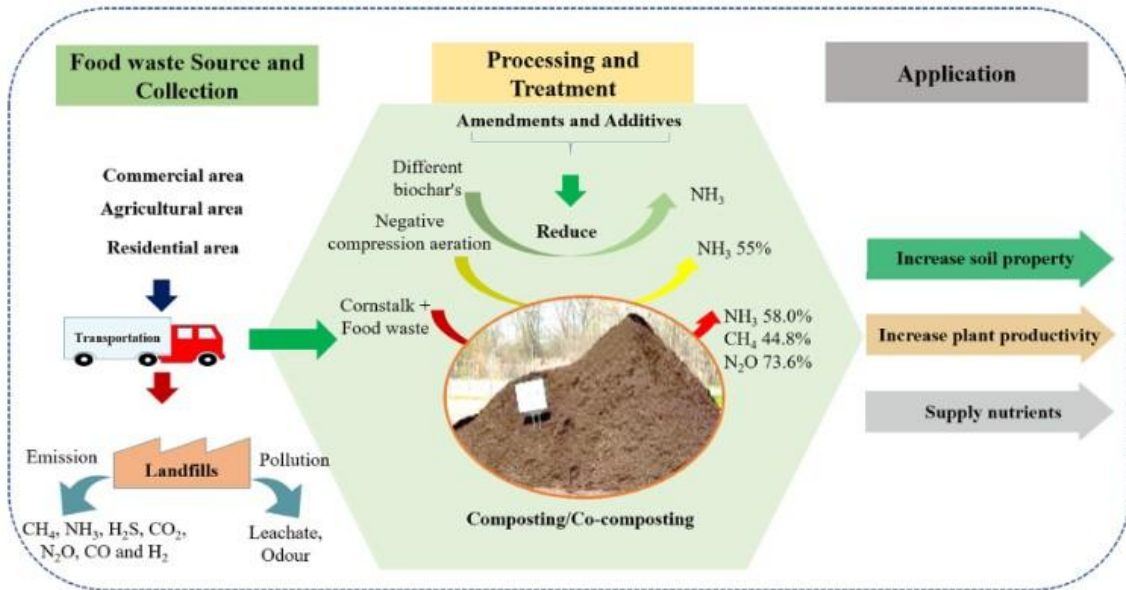
Εικόνα 2. Πηγές απορριμμάτων τροφίμων και η κομποστοποίησή τους για την μείωση των αερίων εκπομπών Πηγή: (Awasthi et al., 2020)
